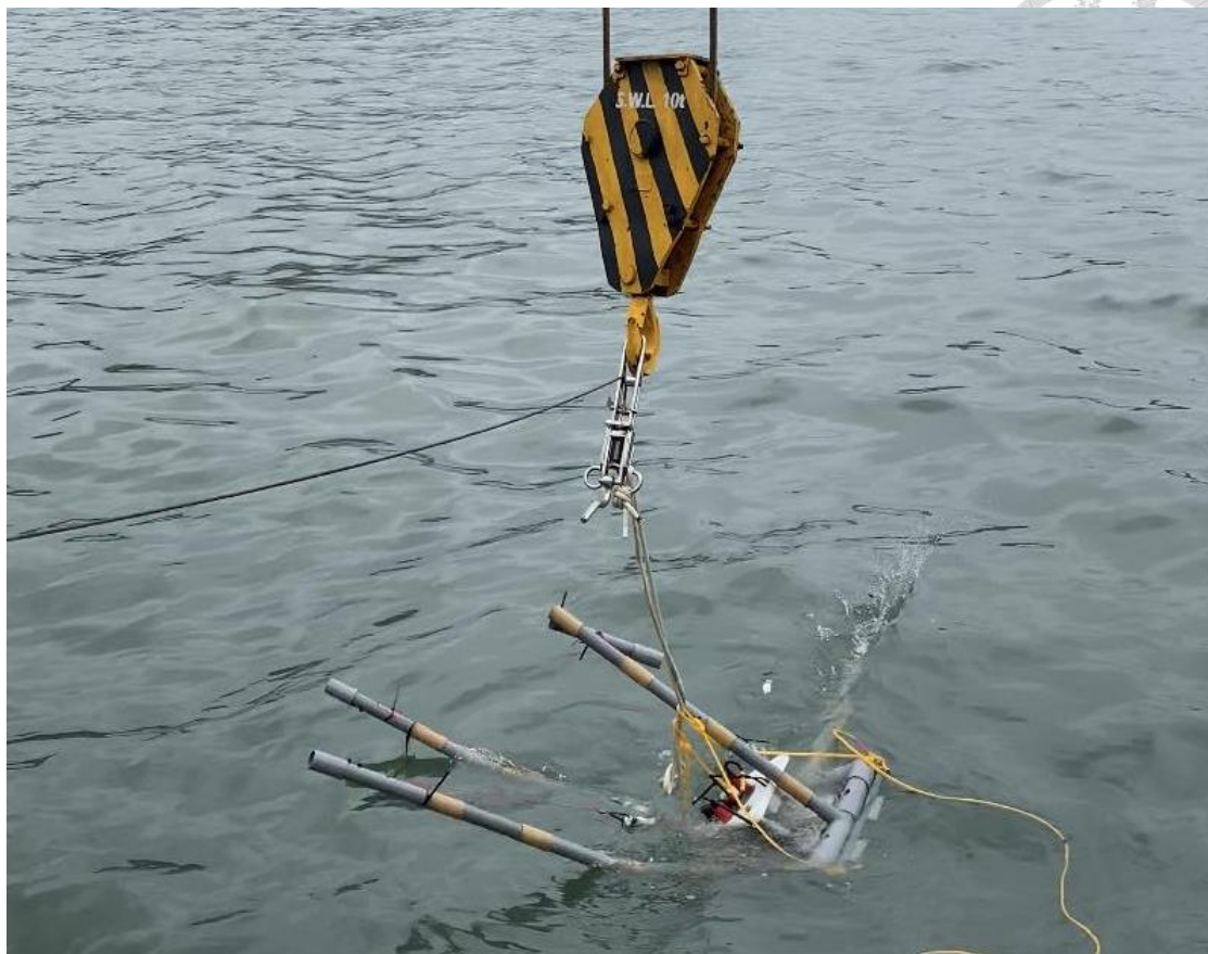
圖 43 SOBEM 入水時因重心與浮心並沒有垂直，剛入水即呈傾斜狀態，且紙巾綁在較低處，故立即浸溼使電極伸展臂無法正交展開。
