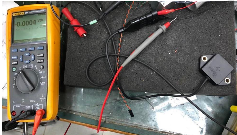
圖 35 Tiltmeter 連接數位電表，隨傾斜角度的不同，電表上的讀數應該會有所變化。
