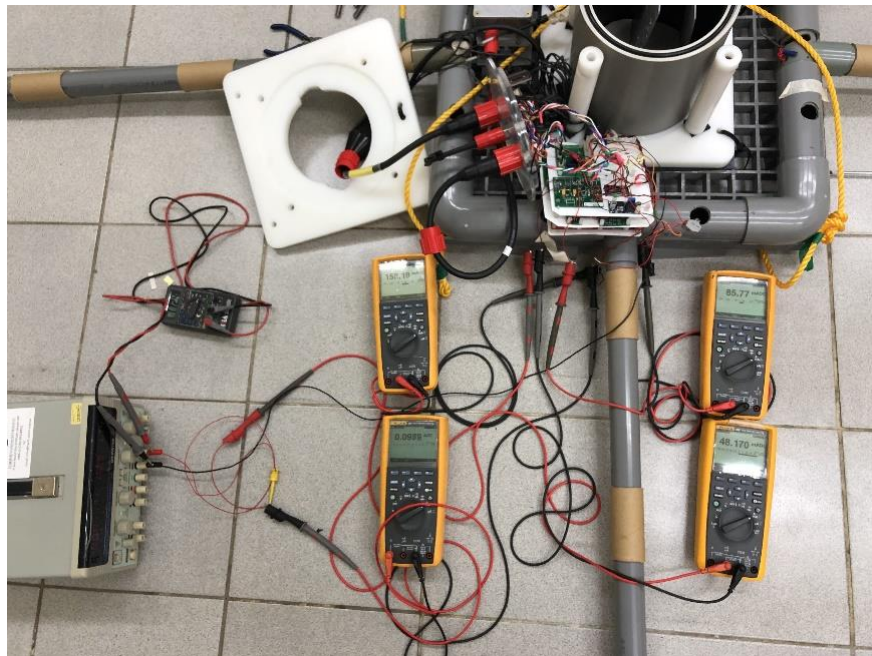
圖 39 電力消耗測試設備連接圖。經由同時使用兩組電錶量測兩組電池組的輸出，分別記錄資料紀錄器和感測器的電流消耗。
