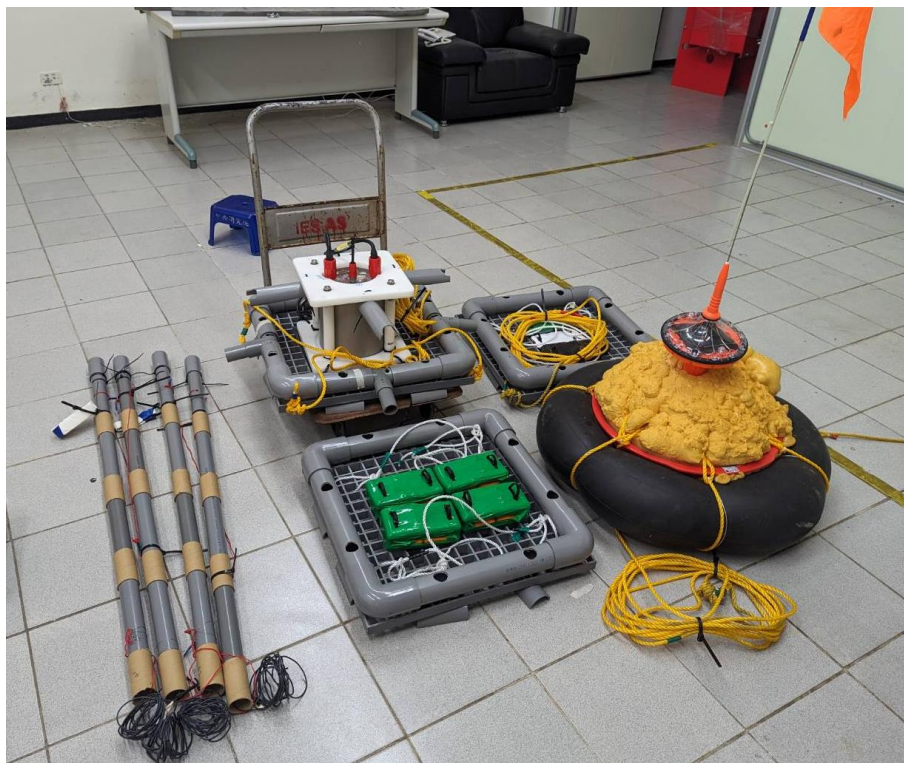
圖 65 將儀器與錨碇之間的繩索解開，並拆卸電極伸展臂，方便運送 SOBEM。
