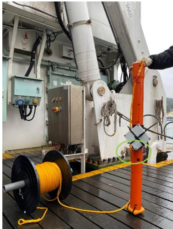
圖 29 將 Tiltmeter 用水密艙體(綠色圓圈處)網綁於 PVC 管上之後以繩索垂放入海中進行測試水密功能。
