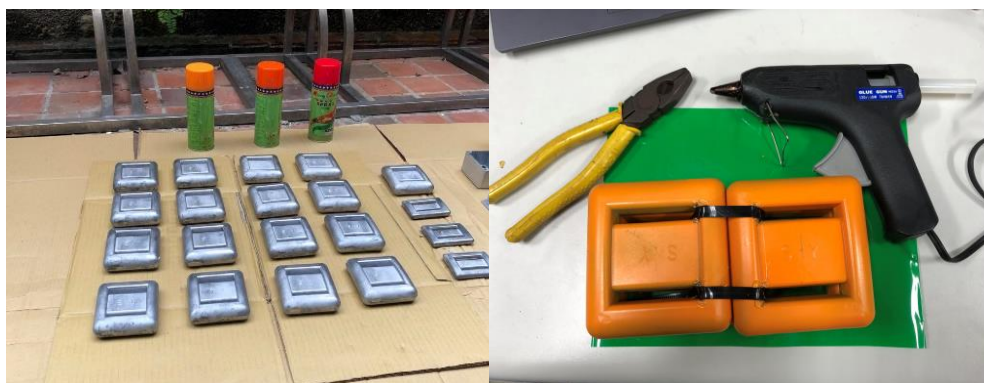
圖 16 潛水伏用鉛塊加工過程。表面噴上一層油漆，再使用熱縮膜包覆，使千塊不會接觸外界造成海洋汙染。
