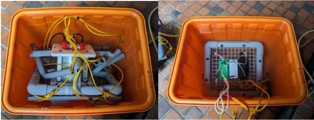
圖 30 在塑膠桶中注滿水，接著分別放入 SOBEM 各部分，以彈簧秤測量水中重量。
