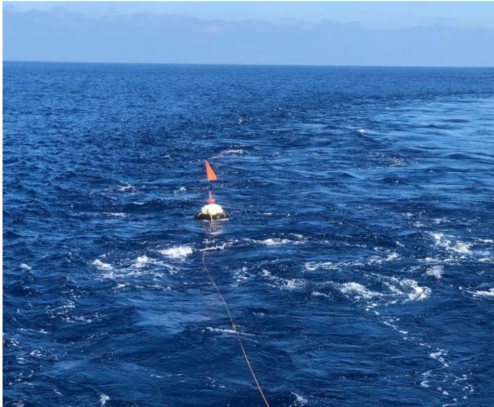
圖 31 AIS 浮標測試。AIS 浮標以繩索綁在甲板的欄杆上，以船隻拖行測試 AIS 浮標的運作情形。
