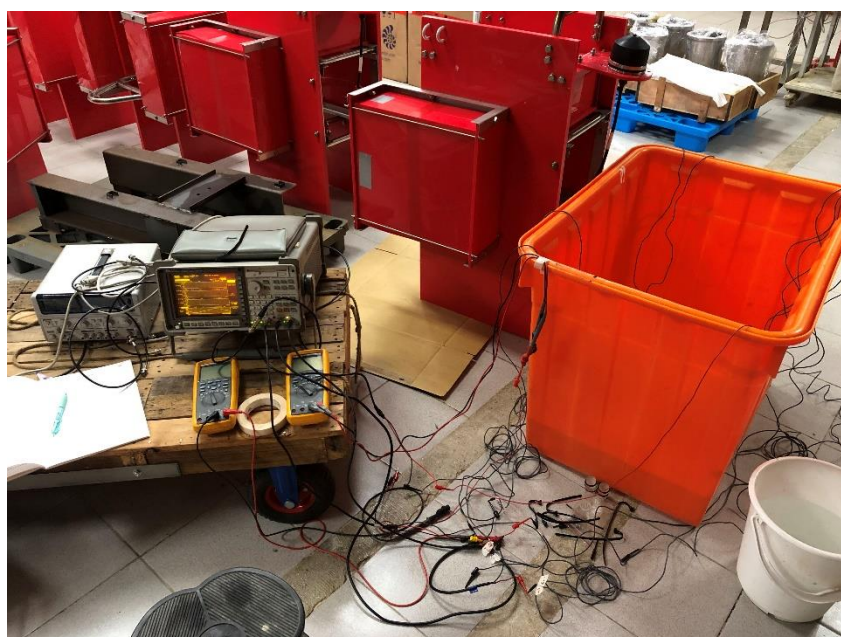
圖 37 電極測試實驗設備連接圖。電極與不銹鋼棒置於裝有 15cm 高的海水的橘色塑膠桶內，並連接動態信號分析儀和數位電表進行量測。
