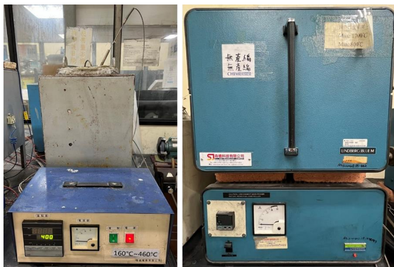
圖 3-16 鹽浴爐（左）與空氣爐（右）
