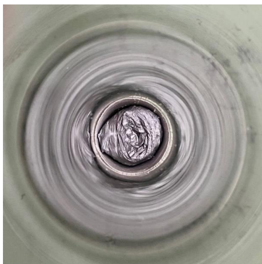
圖 3- 6 無法順利噴鑄之 TiNi 材料殘餘於石英管內
