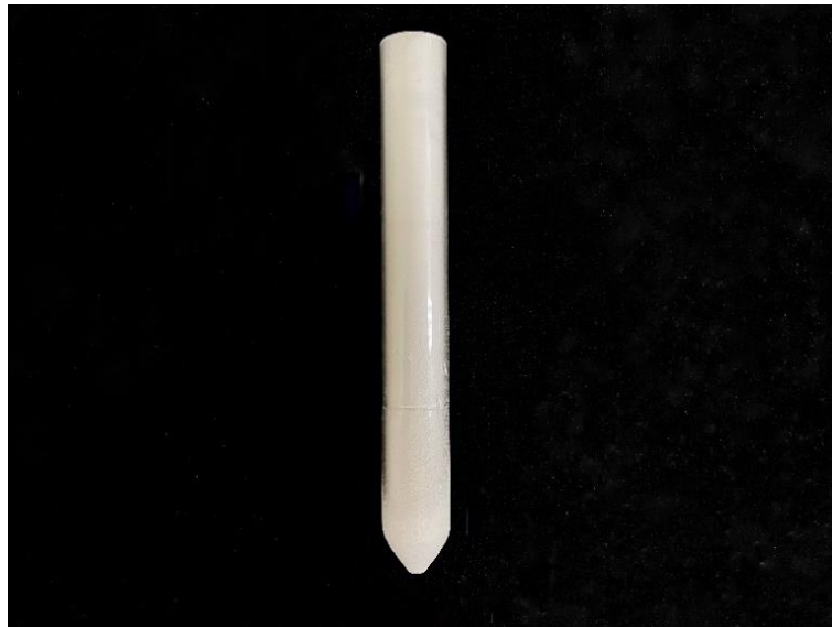
圖 3-8 以氮化硼噴塗完成後之石英管
