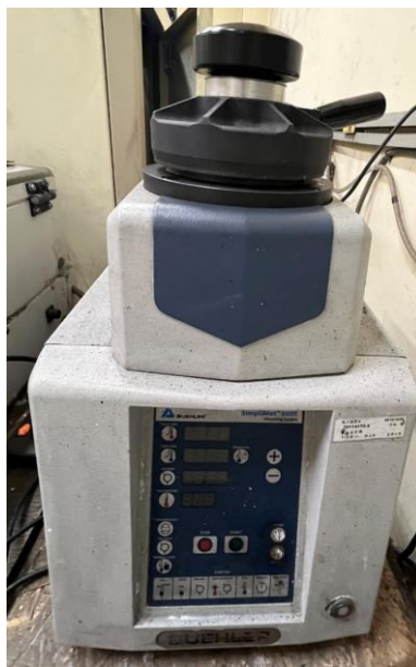
圖 3- 14 Buehler SimpliMet 4000 鑲埋機
