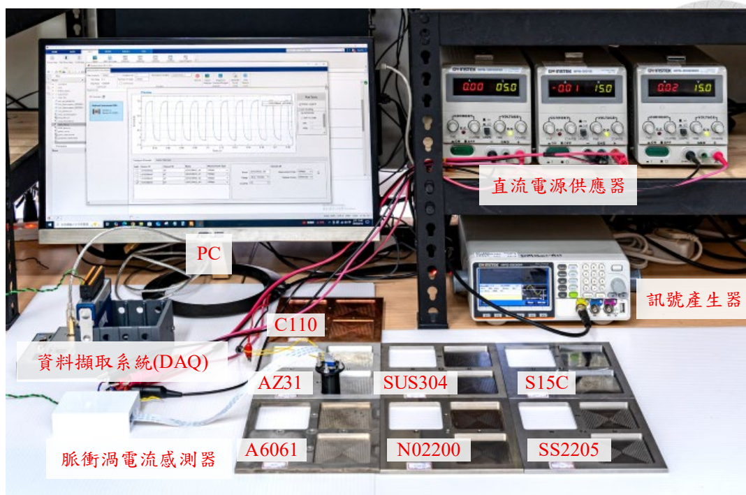
圖 4.7 脈衝渦電流實驗架設
