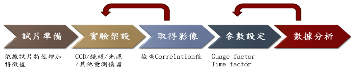
圖 6.11 數位影像相關法操作流程
