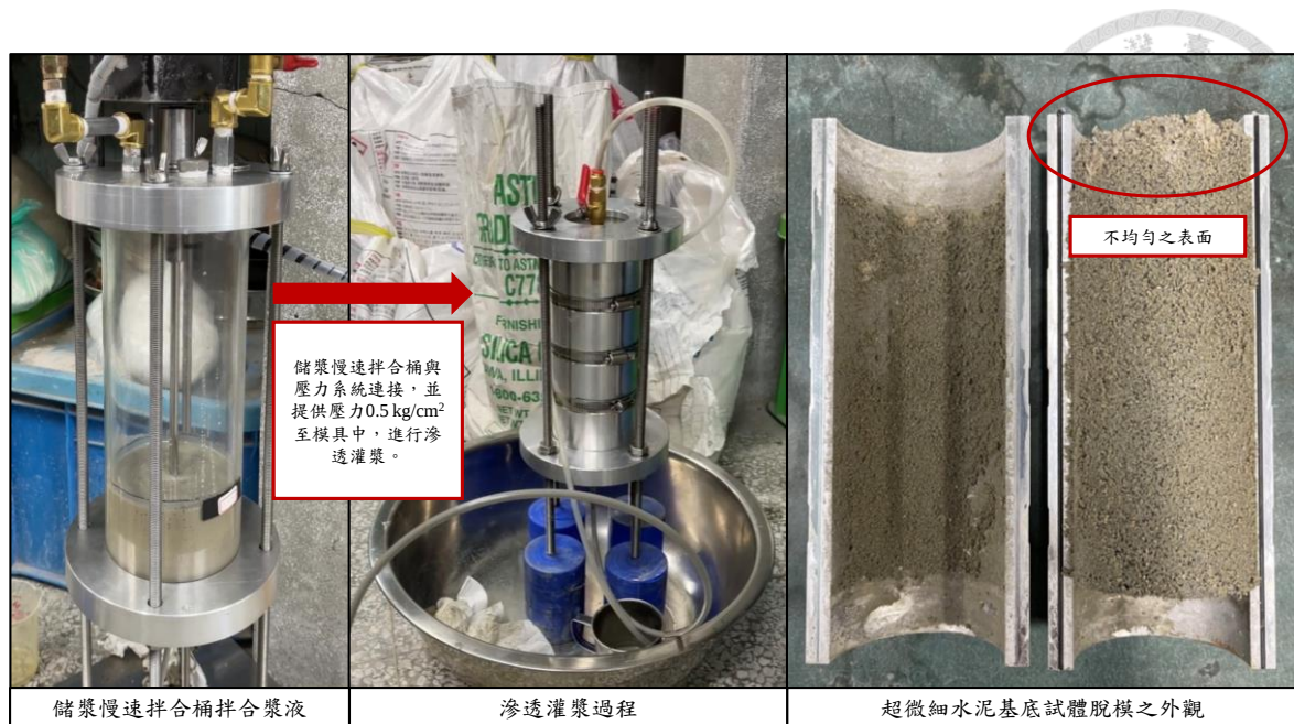
圖 3.20、滲透灌漿之過程與試體經養護後的結果
