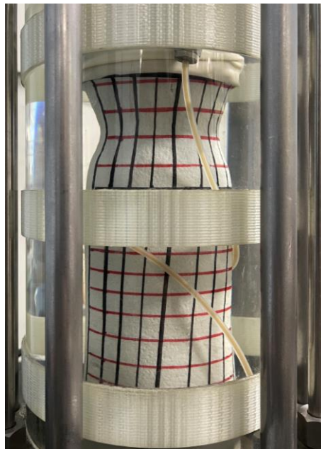
圖 4.19、PS 試體經動態試驗後之液化情形
