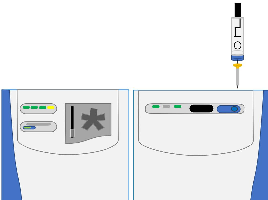
圖 8 頂空氣相層析質譜儀示意圖，右上方樣品進樣處則改以手動將固相微萃取法所萃取出之樣品打進入樣口。
