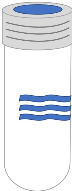
圖 5 Thermo Scientific™ Glass Crimp Top Headspace Vials 20 毫升頂空瓶，將待測物加入瓶內後將帶有軟塞的旋蓋旋緊，萃取時再藉由穿過軟塞進行後續萃取。
