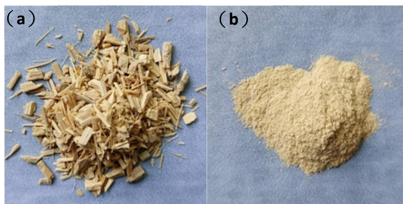
圖 3-1 (a) 經打粉機磨碎之去皮竹粒片；(b) 球磨後之竹粉
