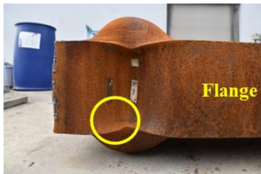
照片 2.15 翼板裂縫 (內側背墊板腹板點銲)
