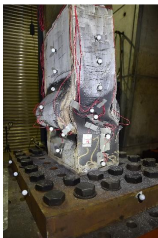
柱底東面腹板 (裂縫)
