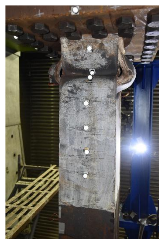
柱頂東、西面腹板 (裂縫)
