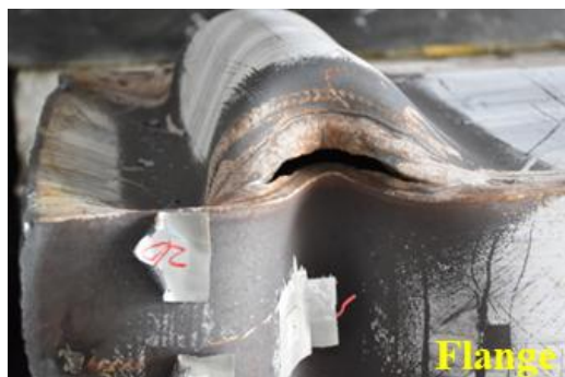
照片 2.15 翼板裂縫 (內側背墊板腹板點銲)
