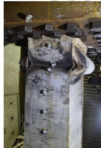
柱頂東、西面腹板 (裂縫)
