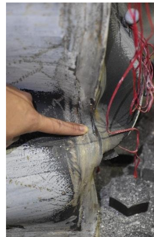
柱底西面腹板 (裂縫)
