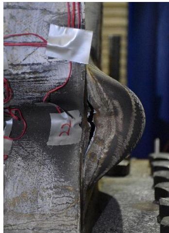
柱底西面腹板 (裂縫)
