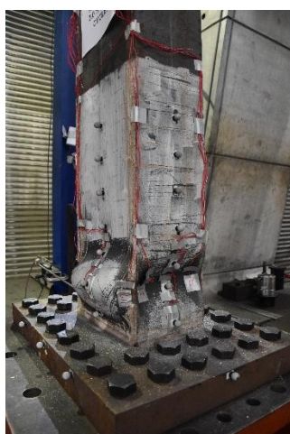
柱底北面翼板、東面腹板
