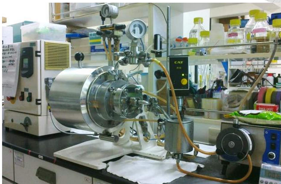
附圖十二、介質研磨設備-循環珠磨機外觀。
