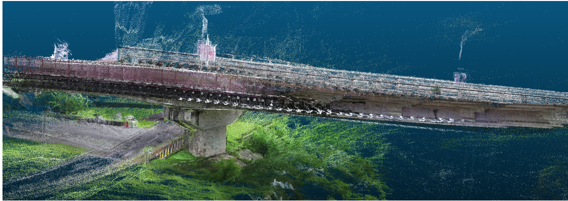
圖 4.24: 道南橋 COLMAP 重建之稠密點雲成果
