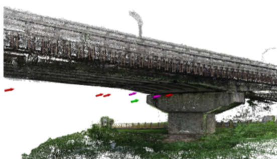
(a) COLMAP 建立之稠密點雲及劣化標註
