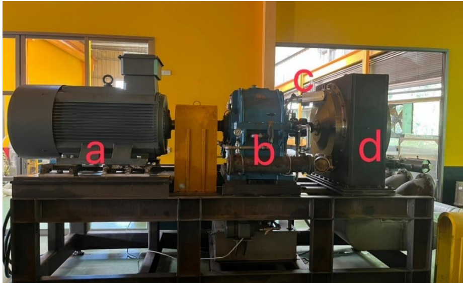
圖 3-8 發電系統 a.永磁發電機 b.變速箱 c.二相流噴嘴 d.斜衝擊式渦輪機
