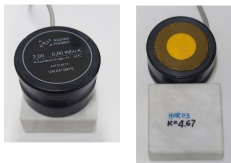
圖2-4-2、表面接觸式探測計及標準樣本( \sim 4.67 \text{ Wm}^{-1}\text{K}^{-1} )。
