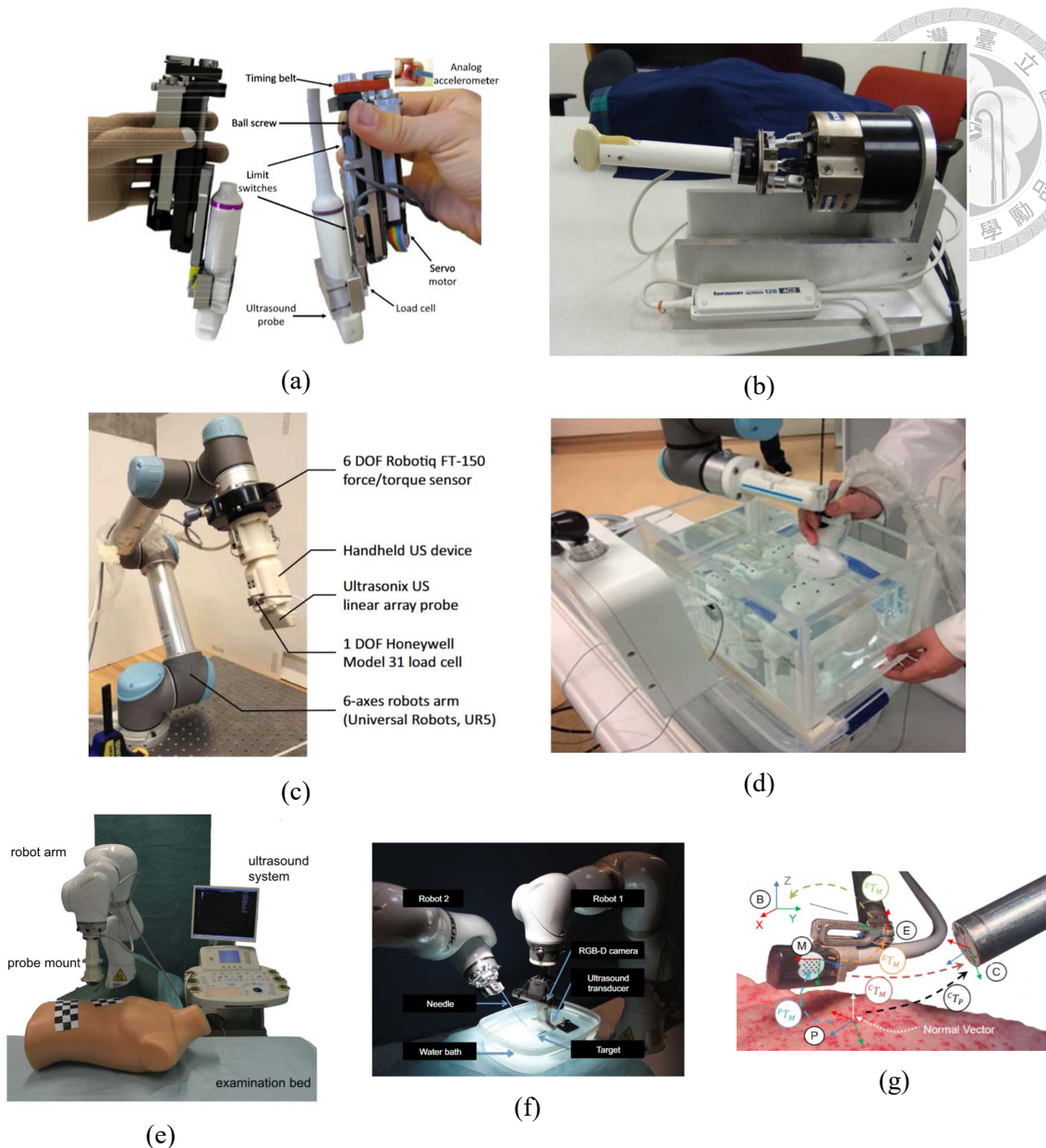
Figure 1.4: 已開發輔助 US 成像的機器人系統示意圖。其中，(a) 手持式 US 探頭系統 [3]，(b) 六自由度的力控制並聯式 US 機器人 [4]，(c) 力輔助的協作型機器人 US 系統 [5]，(d) 3D 立體 US 影像獲取的機器人系統 [6]，(e) 雙機械臂的 US 導引介入式治療機器人系統 [7]，(f) RFA 機器人系統 [8]，(g) 視覺伺服補償組織運動的掃描架構 [9]。
