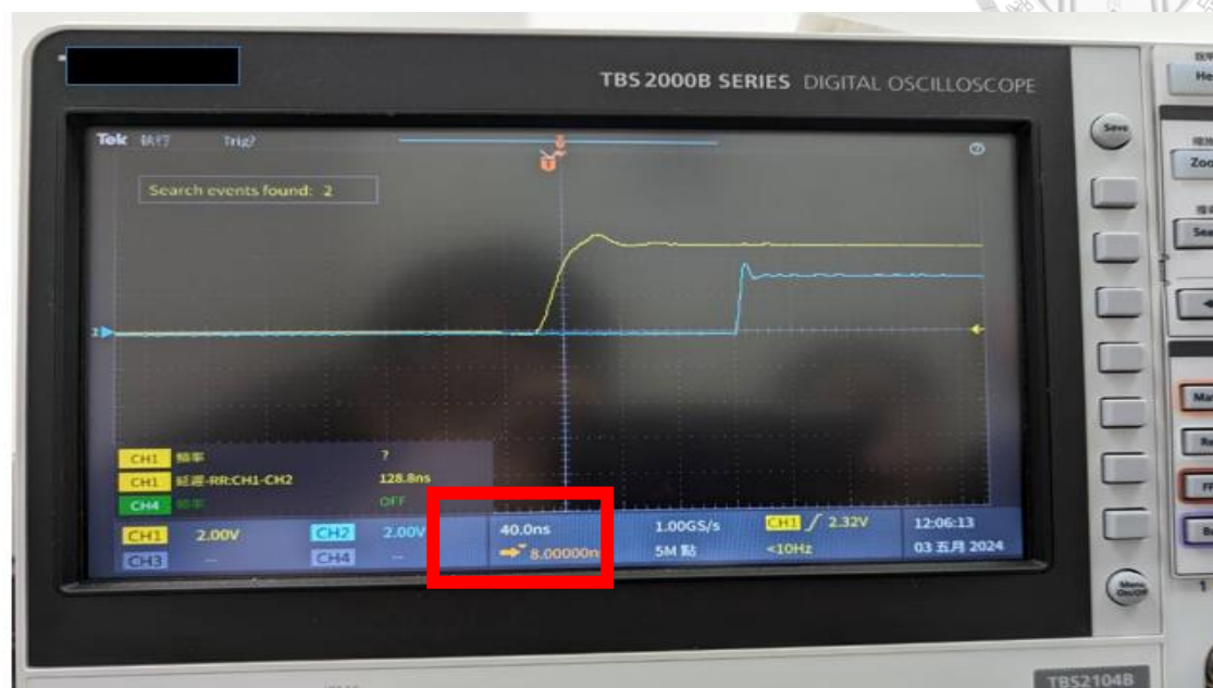
圖 31 IED 時間同步精準度量測
