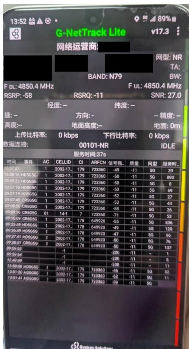
圖 17 手機端確認 5G 系統正常
