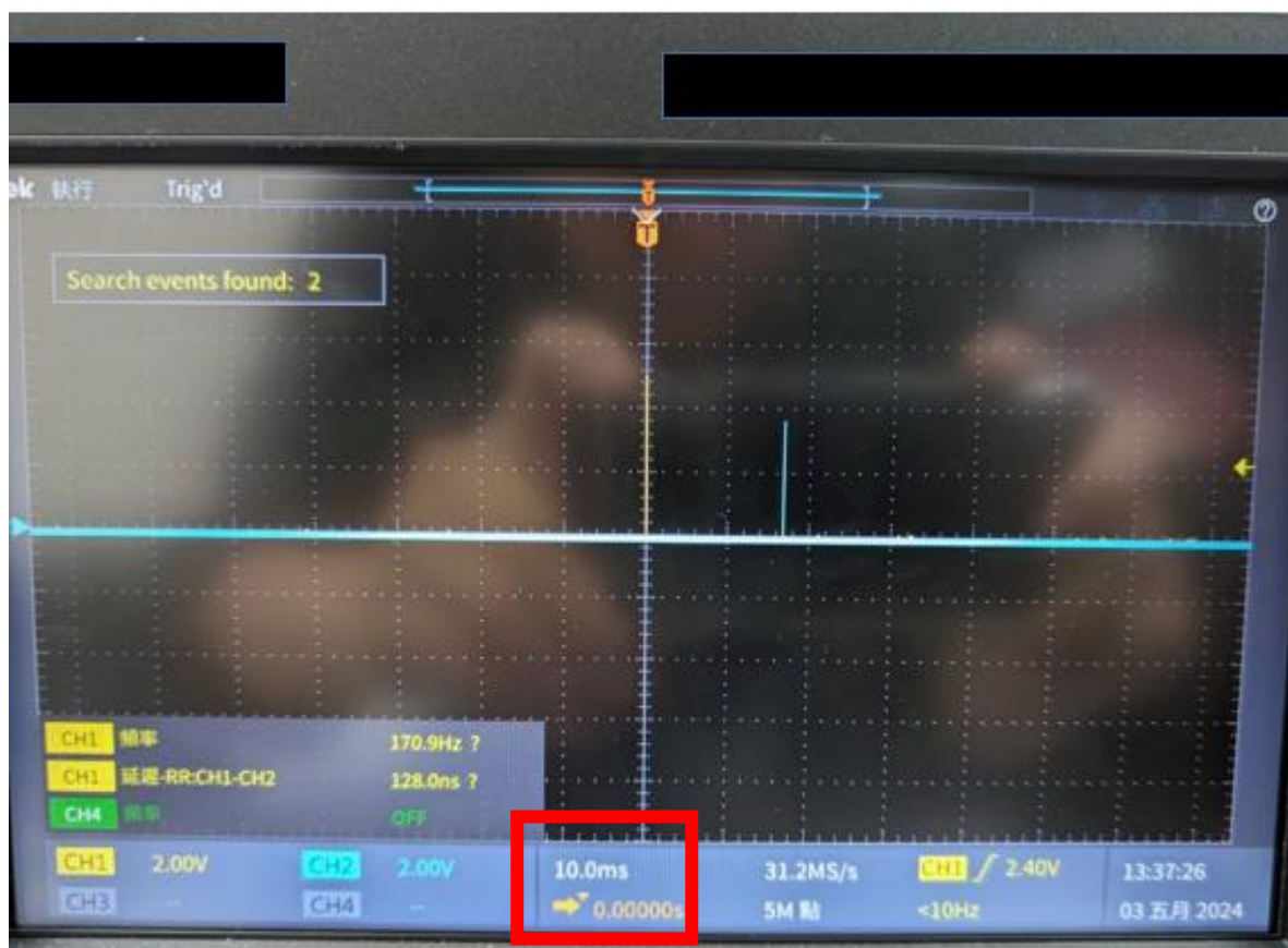
圖 38 IED 與 GPS 時間不同步
