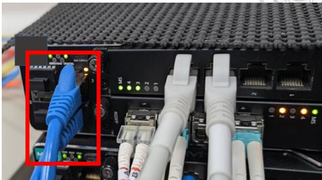
圖 41 模擬時間同步備援機制
