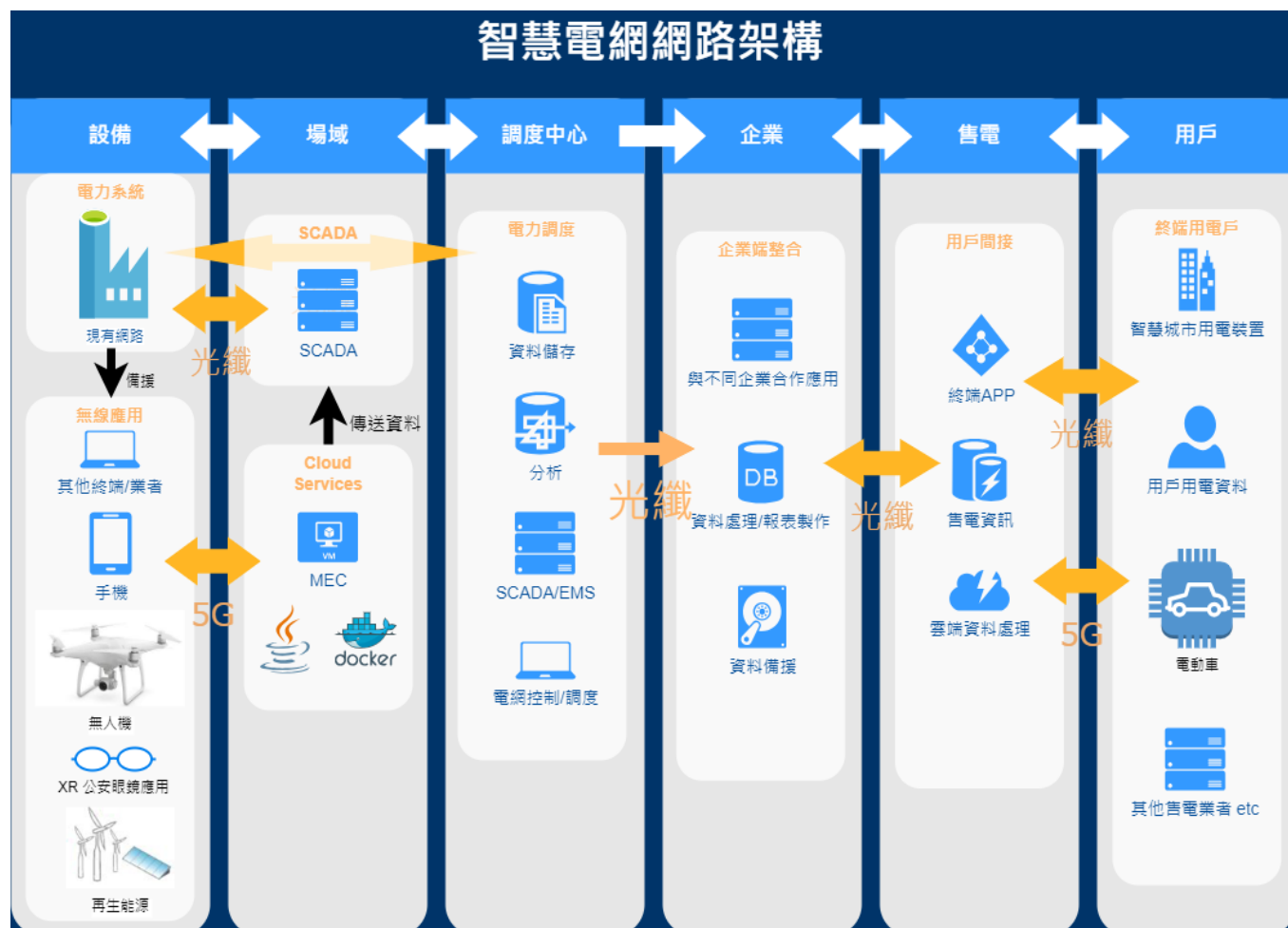
圖 11 5G智慧電網網路架構圖
