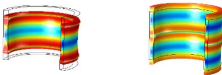
圖 4-3、本研究模擬之第二軸向振動模態
