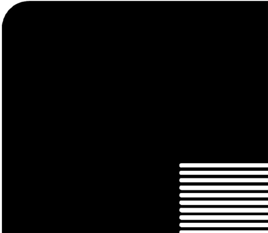
圖 3-10 適用於 1000  $\mu\text{m}$  之鈮酸鋰晶片電極鋪設光罩局部圖
