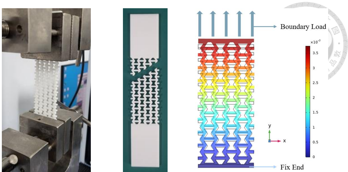
(a) 試驗試體 (b) 試體破壞狀況 (c) 數值模擬變形及邊界設定
