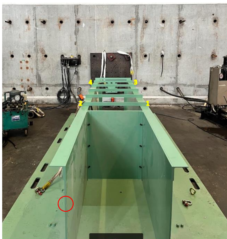
圖 6.6 鋼製容器 x 向敲擊點位與監測點位
