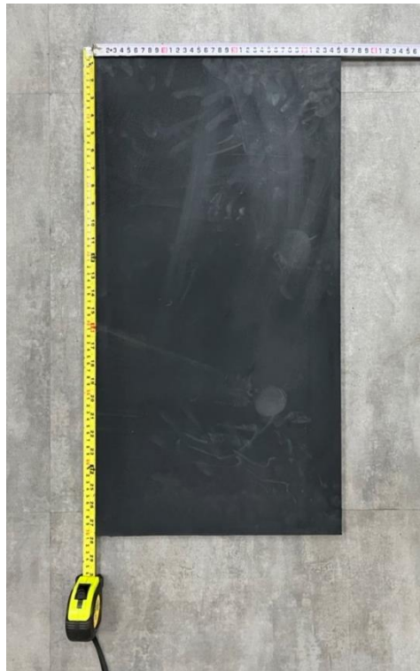
圖 5.22 橡膠試片規格 35cm×65cm
