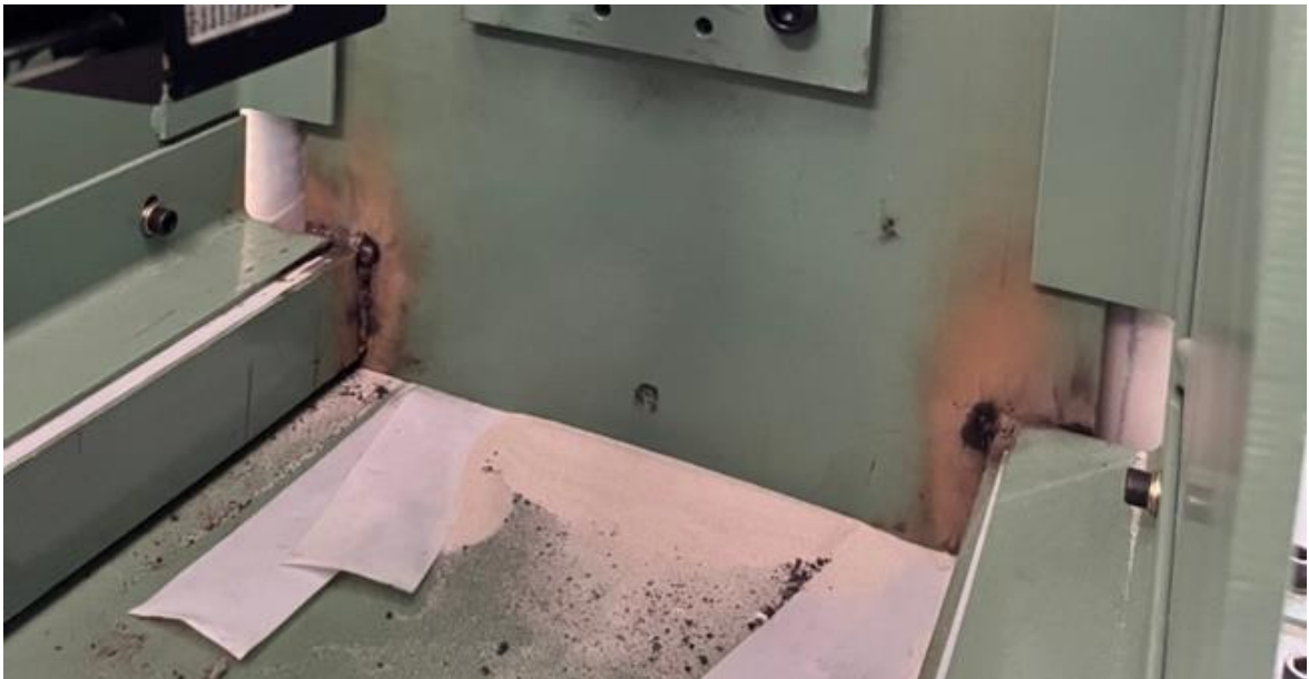
圖 6.38 可移動鋼板底部漏砂情形
