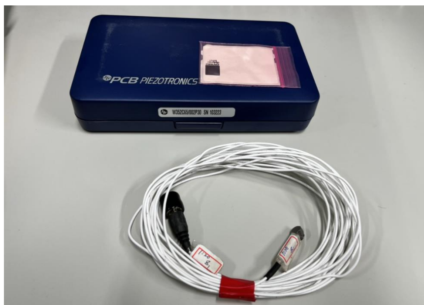
圖 5.32 試驗使用微型加速規
