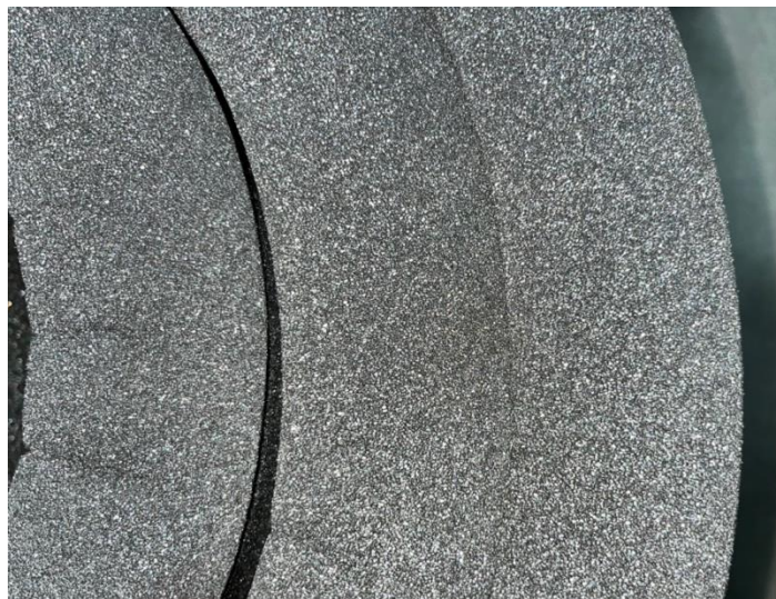
圖 5.25 模擬低反射邊界之泡棉 規格厚度 5cm
