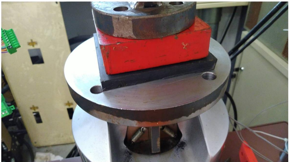
圖 5.21 萬用試驗機放置橡膠試片情形
