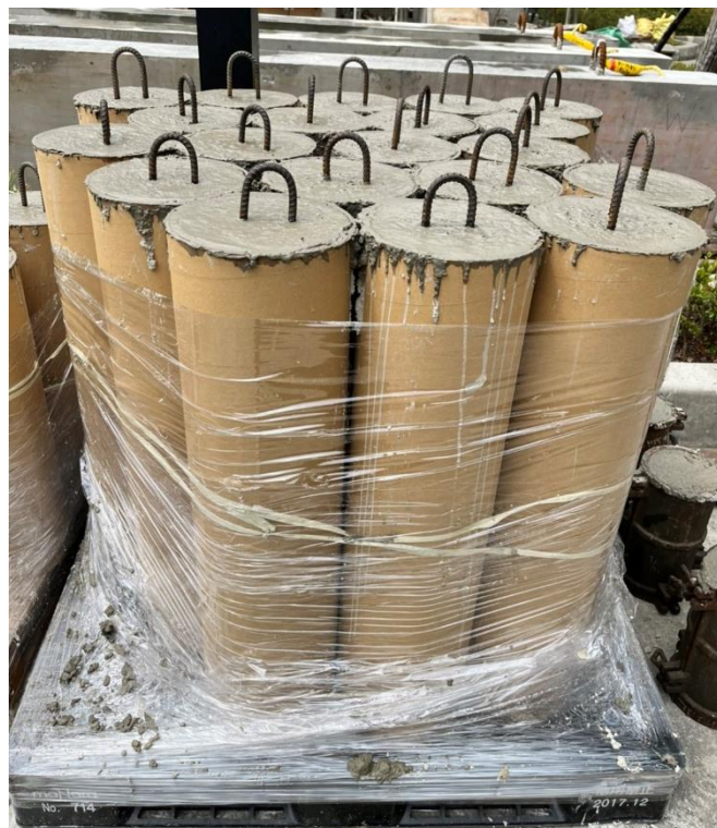
圖 5.17 混凝土圓柱實際澆注情形
