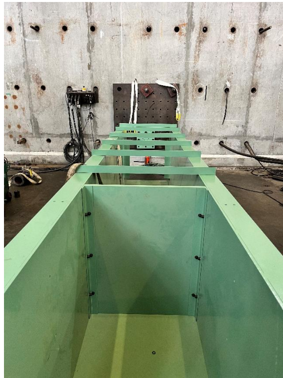
圖 5.11 鋼製容器組立完成後視圖
