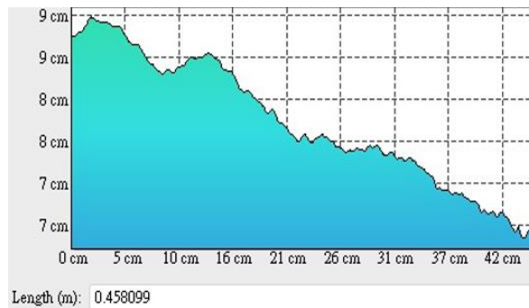
(f) 試驗步驟五拆除四支調整塊,與原始 DEM 相比平均淤積深度 4.35cm,實際增加 2.175m
