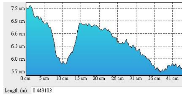
(e) 試驗步驟四調升五支調整塊，與原始 DEM 相比平均淤積深度 1.85cm,實際增加 0.925m
