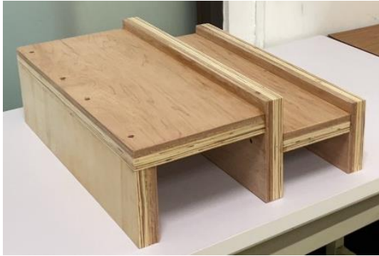
(A) 木製第一及第二固床工
