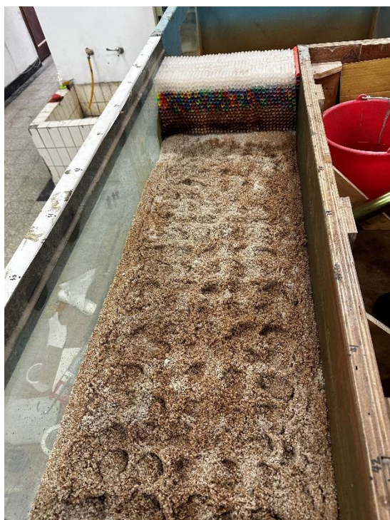
(C) 夯實後上游上半部份土砂狀況
