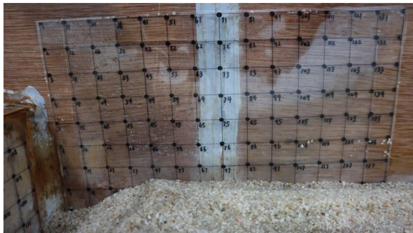
(C) 實驗渠道左岸的控制點
