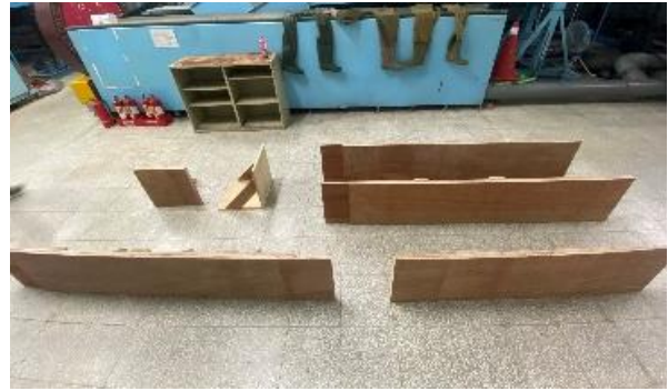
(B) 渠槽分流用木製隔板(正面)
