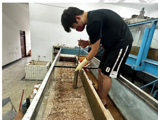
(B) 試驗渠道進行夯實下半部份
