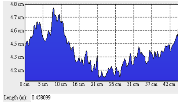
(a) 試驗原始 DEM，平均土砂高程 4.5cm，實際高程 2.25m
