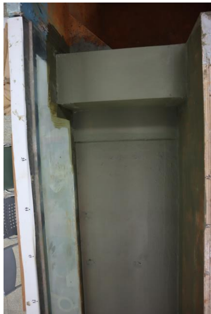
(G) 實驗渠道內之高水墩
