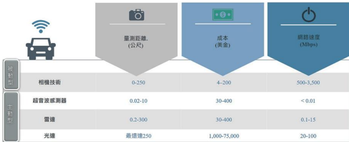
圖 11. 感測器特性、應用距離、價格及網路速度之比較。資料來源：STPI; 科技發展觀測平臺。
