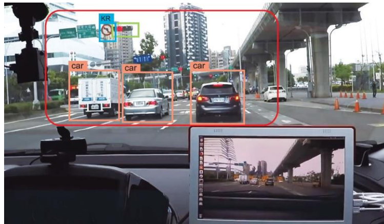
圖 41.自駕車基本要具有可以辨識交通號誌、車輛及用路人之障礙物偵測系統
