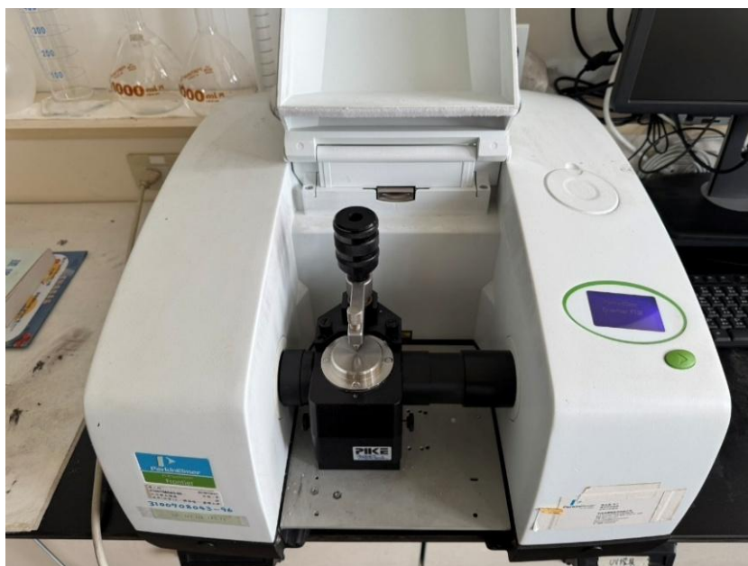
圖 3-4 ATR-FTIR 機台實體圖
