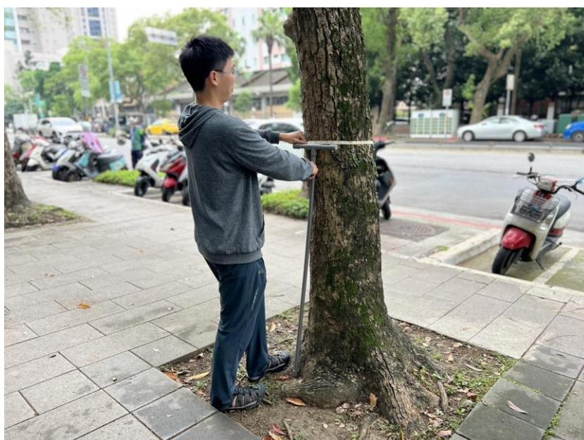
圖 3.5 本研究運用 1.3m 之標示桿以進行測量位置確認
