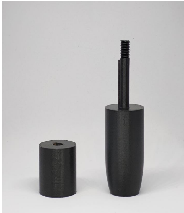
圖 9 無葉片的螺槳轂部(左)連結機構(右)
