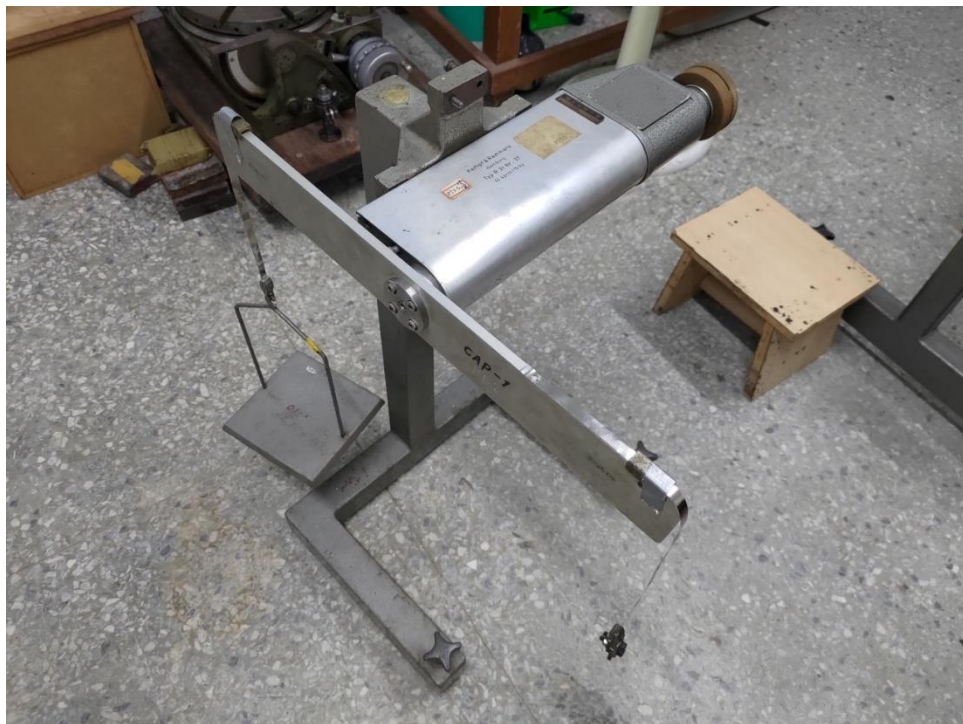
圖 18 動力儀扭矩校正架設
