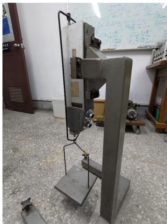
圖 16 動力儀推力校正架設
