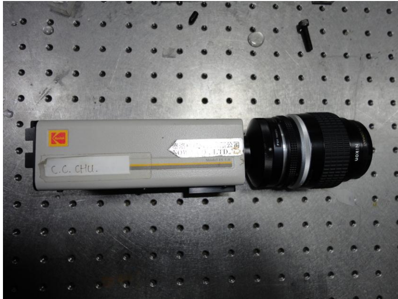
圖 14 電子耦合攝影機(CCD)與 Nikon 35mm 定焦鏡頭
