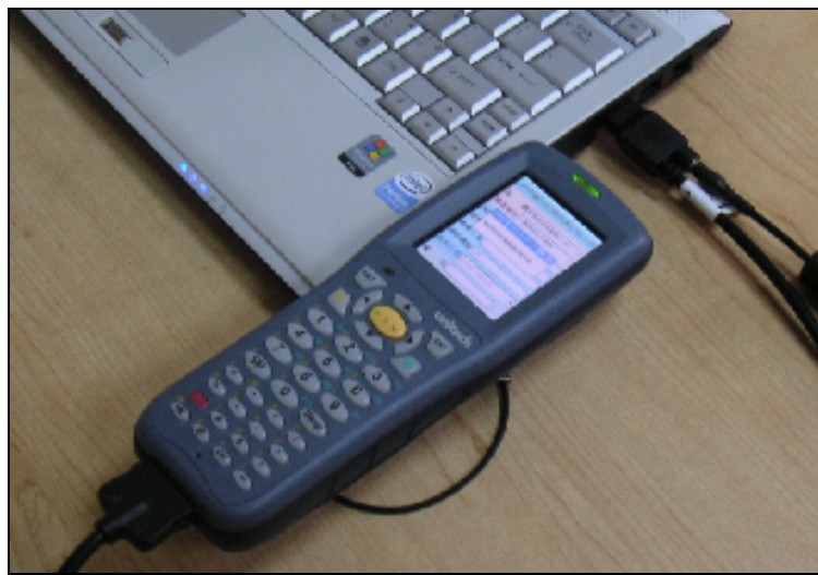
圖-45 PDA 資料傳輸線連接 USB
