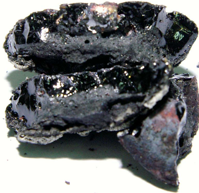
圖 4.37 為添加鐵粉之合成污泥 S02 經 30 分鐘改良式微波燒結技術後之燒結體的斷面圖
