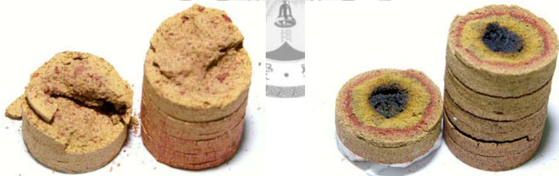
圖 4.37 為添加鐵粉之合成污泥 S02 經 30 分鐘改良式微波燒結技術後之燒結體的斷面圖
