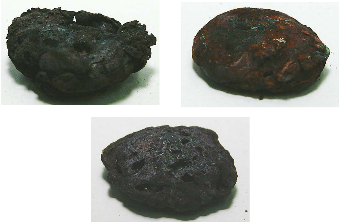
圖 4.27 經微波燒結技術後之污泥燒結情形(以 800W-30min 為例) 左上：SC；右上：SC+氧化鐵；中下：SC+鐵粉
