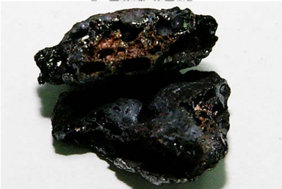
圖 4.28 添加鐵粉之合成污泥 S02 經 30 分鐘燒結後之燒結體的斷面圖
