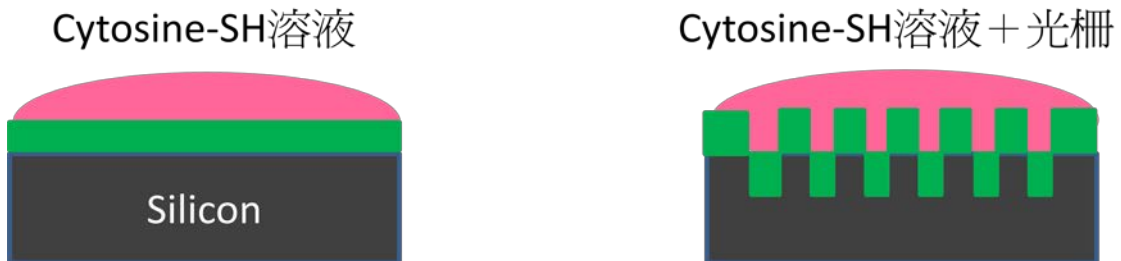
圖 4-3-22 去除自組裝薄膜之實驗比較圖
