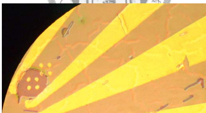
圖 5-20.，這是顯影過後之圖，由圖可看定位點周圍因為打電子束的關係，所以電子阻被打掉了，但在其右上方及遠右方，可看出有奈米線在沒有打電子束的地方，其上卻沒有電子阻液殘留。
