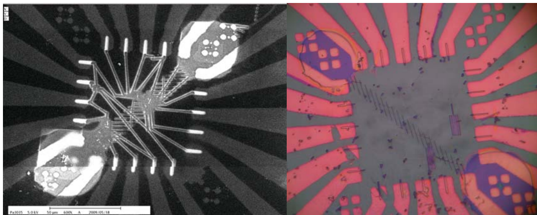
圖 5-17.定位時的痕跡，會使中間繪圖區域的獨立線路連通而造成失敗。
