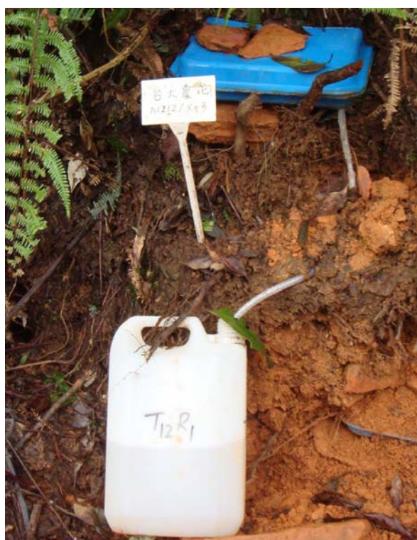
圖 9、地表逕流水收集裝置 Fig. 9. A surface runoff collector
