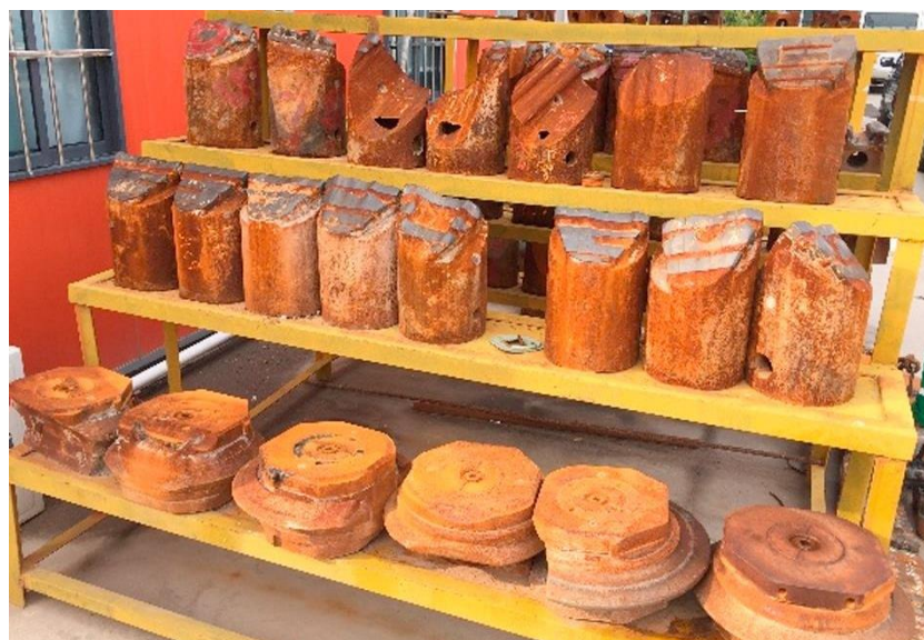
圖 1.1.2 潛盾機切削刀具破壞之示意圖(Huang et al., 2018 [2] )
