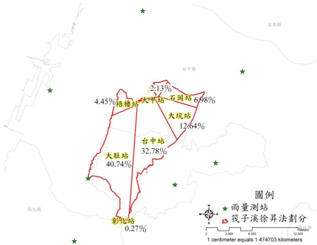
圖 3.21 筏子溪流域徐昇法面積權重示意圖
