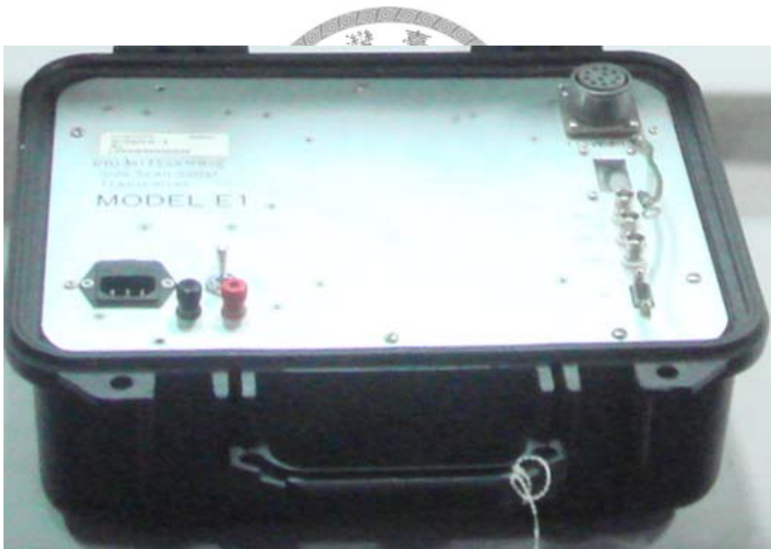
圖 2- 4、ST-8000 側掃聲納主機圖。拖魚所接收之訊號，傳至此 ST-8000 側掃聲納主機上，可將資料以紙面影像呈現，或傳至個人電腦上，予以數位化儲存。
