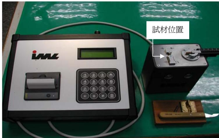
圖 4 IML 微破壞儀 (Fractometer)
