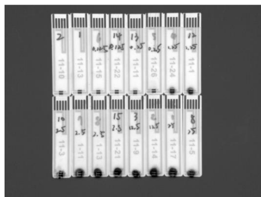
圖 4- 39 不同濃度抗體與 10 mg/ml BSA 結合後的 ECL 呈色分析。將製備好 NC 與絕緣層的碳電極泡進濃度 10 mg/ml 的蛋白溶液進行吸附，然後量測的電容值作為初始電容值再將不同濃度的 Anti-BSA 滴在電極反應區，一小時後用 PBS 清洗最後將二抗滴在結合區再淋上 ECL 混合試劑進行冷光造影。
