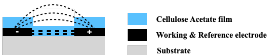
圖 3-1、網版印刷碳膠電極之電場分佈強度示意圖。
