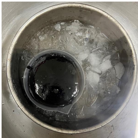
圖 4.4 搭接劑的調配參數經改善後之脫泡過程
