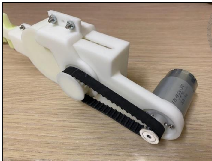
圖 3-27 原型機 1 傳動系統皮帶部分
