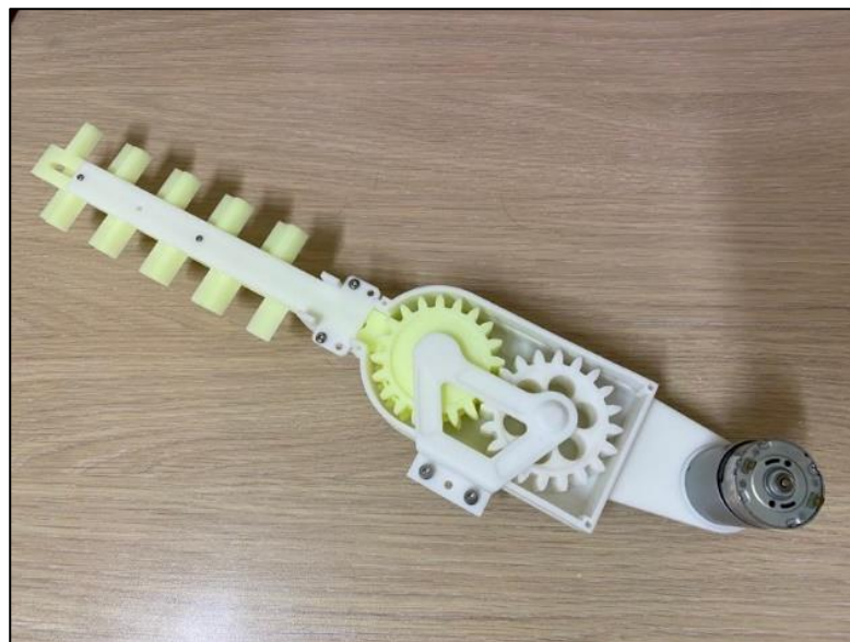
圖 3-26 原型機 1 3D 列印模型組裝
