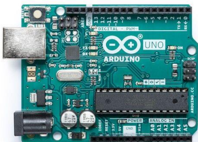
圖 3-35 Arduino Uno 開發板
