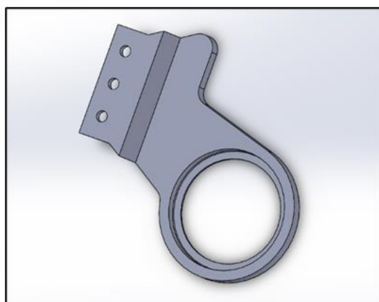
圖 3-23 原型機 1 下層齒輪支撐架
