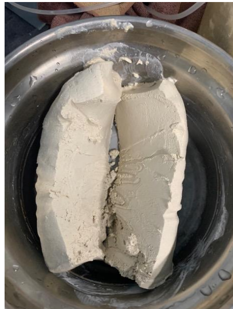
圖 4.17 試體 PI14 經動態試驗後之液化情形
