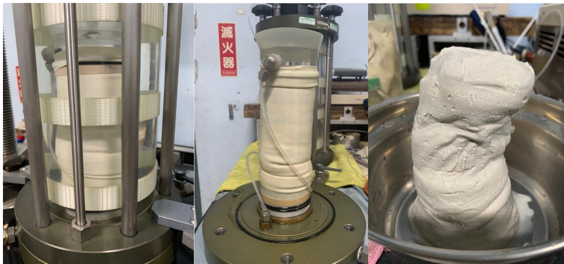
圖 4.13 試體 PI08 經動態試驗後之液化情形
