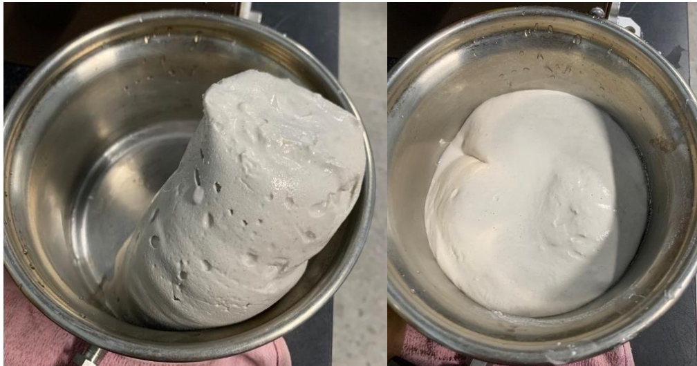
圖 4.9 試體 PI04 經動態試驗後之液化情形
