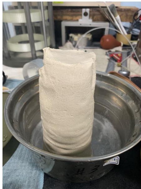
圖 4.17 試體 PI14 經動態試驗後之液化情形
