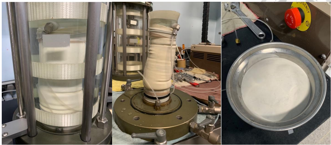
圖 4.4 試體 PI00 經動態試驗後之液化情形
