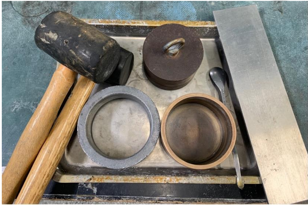
圖 3.4 日本法相對密度試驗儀 JSF (T26-81T)
