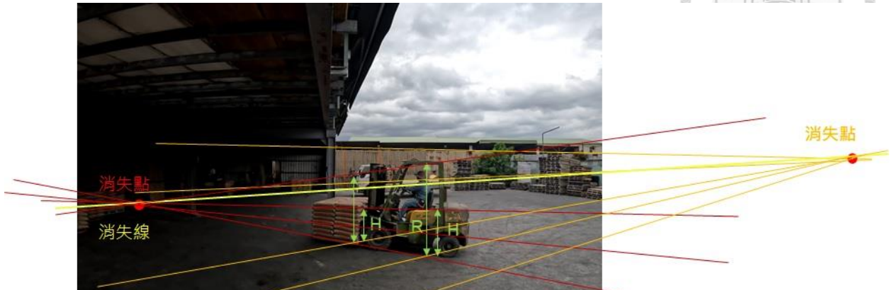
圖 3-4 單視立體高度測量透視圖
