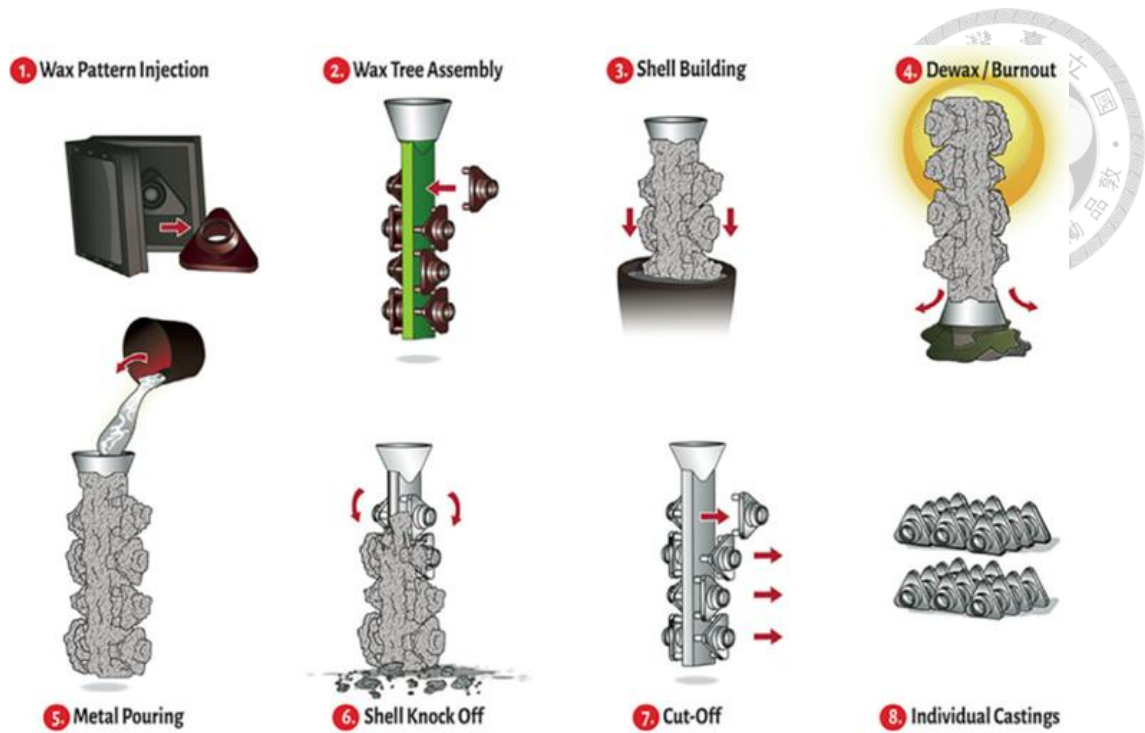
圖 2.2-1 陶瓷外殼熔模鑄造的基本步驟[30]
