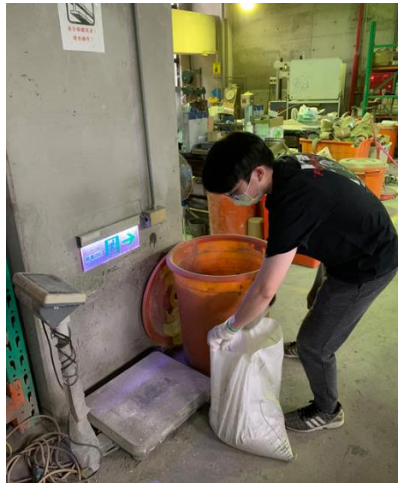
圖 3-5 拌合混凝土備料過程
