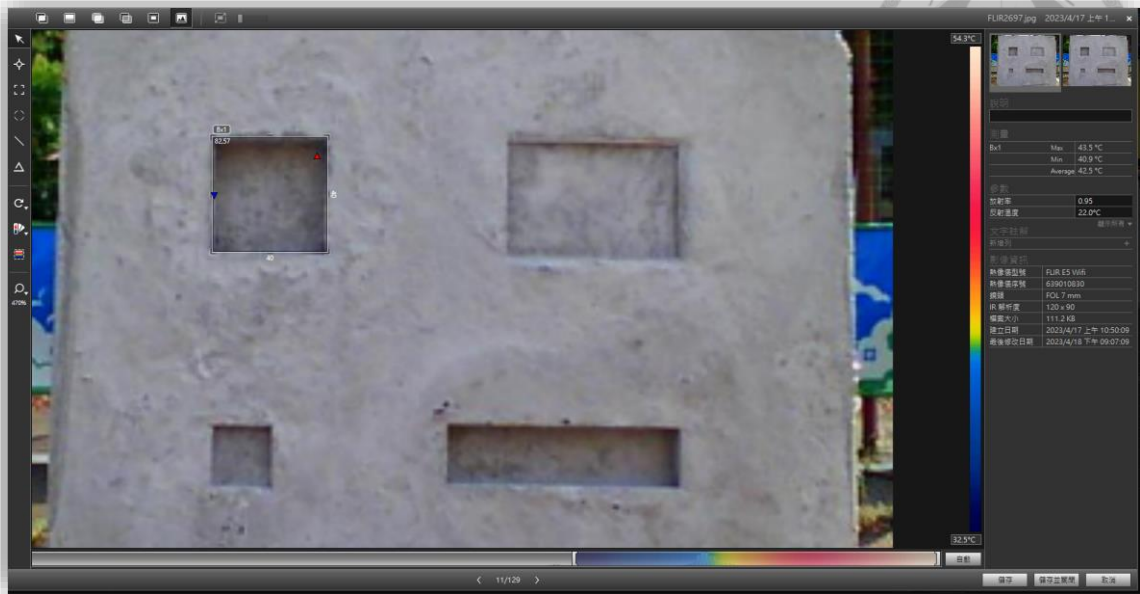
圖 4-3 於可見光影像選取缺陷溫度值之範例
