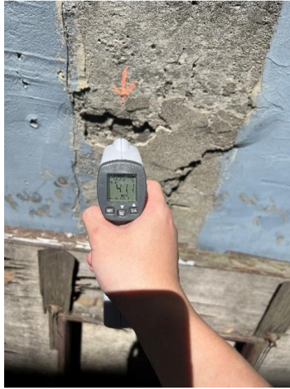
圖 5-4 使用紅外線溫度計 TECPEL-DIT300B 量測缺陷之表面溫度
