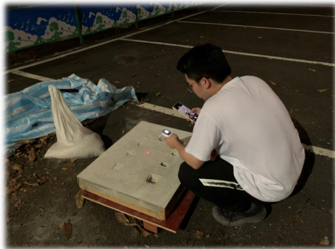
圖 4-2 量測試體之表面溫度示意圖
