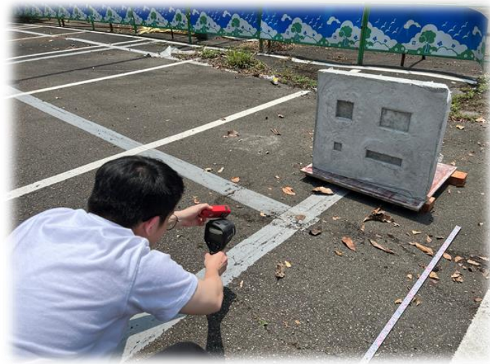
圖 4-1 使用被動紅外線熱成像技術量測試體示意圖
