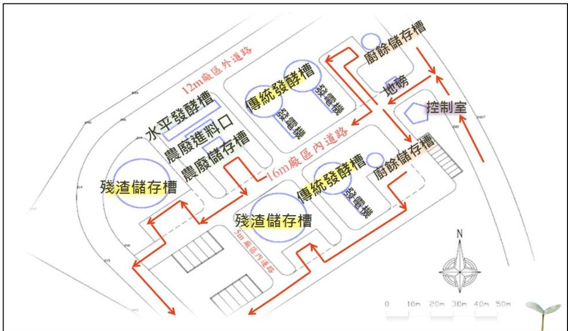
圖 4.3.2-4 生質能源再利用廠廠區規劃與動線示意圖
