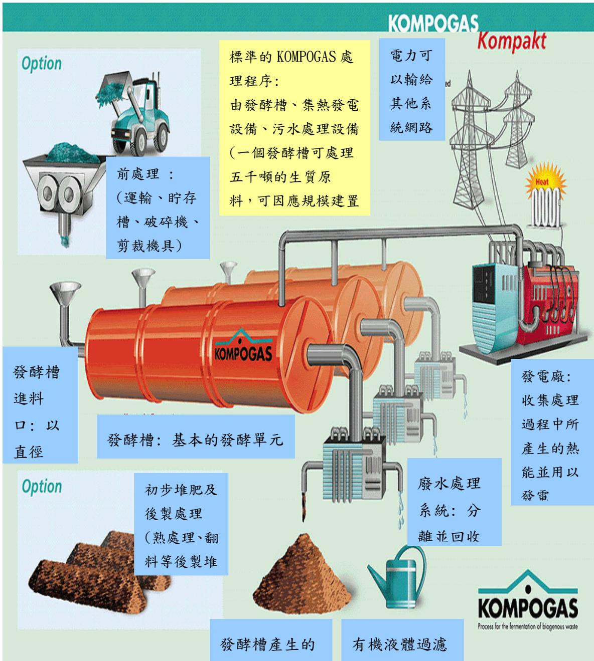
圖 2.3.1-1 kompo gas 處理過程示意圖
