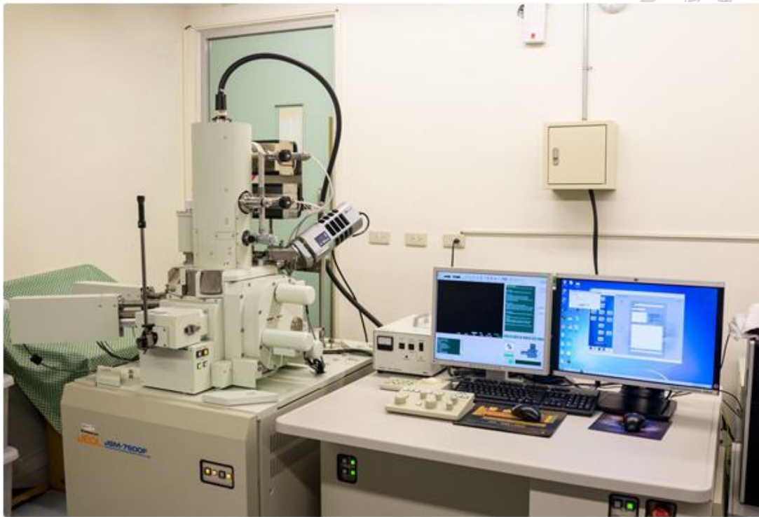
圖 3.14 JEOL JSM-7600F 場發射掃描式電子顯微鏡外觀圖。
