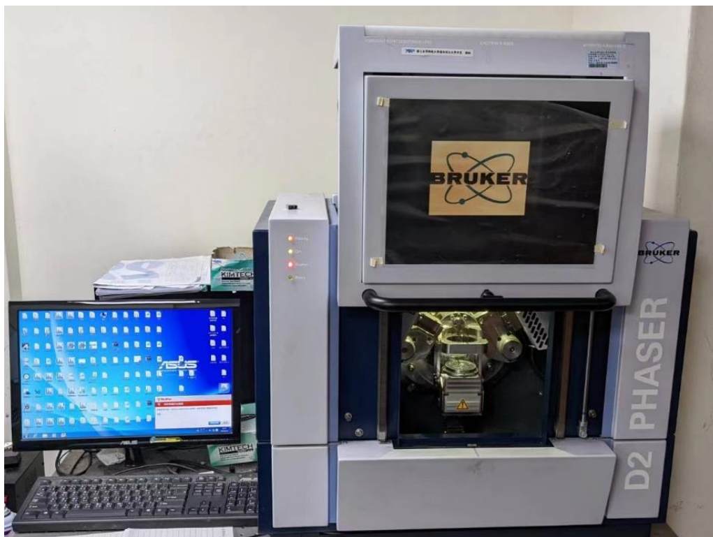
圖 3.13 Bruker X 光繞射分析儀外觀圖。型號為 D2 - PHASER，使用銅靶作為靶材。
