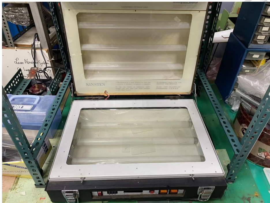
圖 3.8 PCB 板曝光機 KINSTEN 外觀圖。
