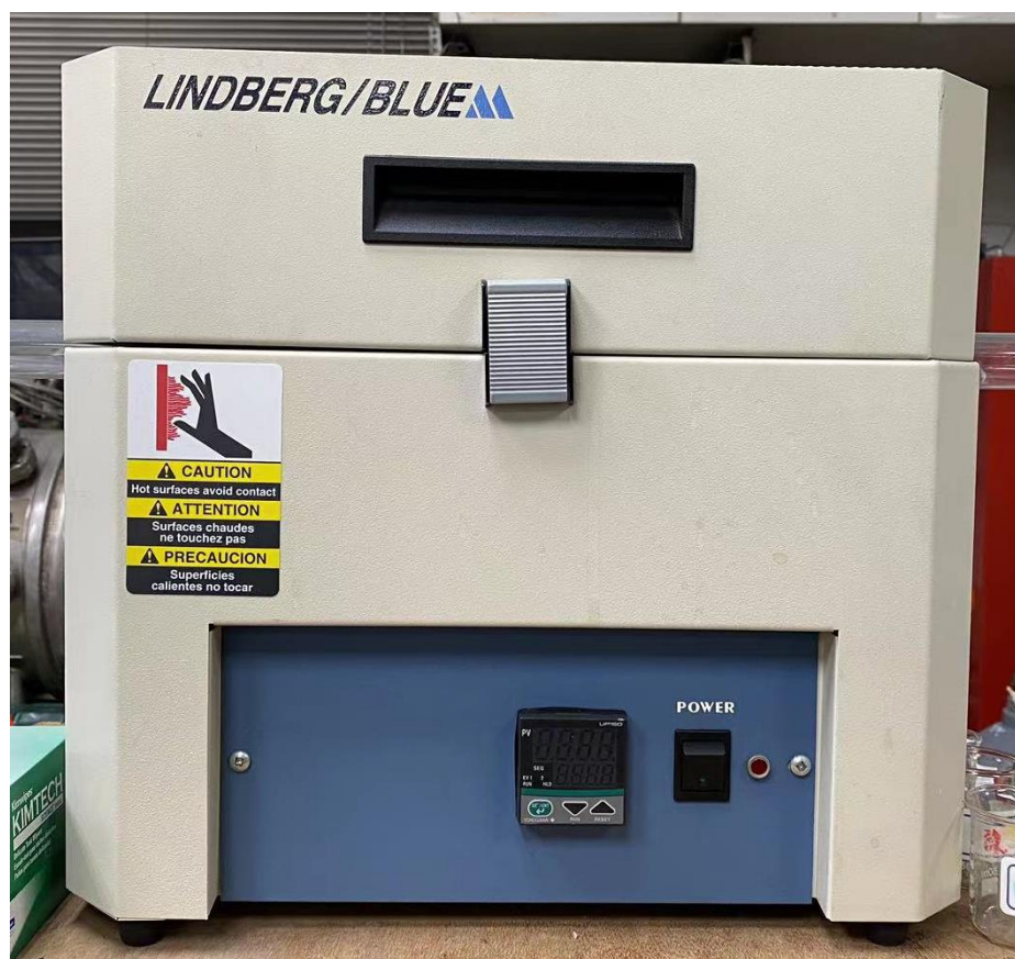
圖 3.7 Thermo 管爐外觀圖。型號為 Linderg/Blue。
