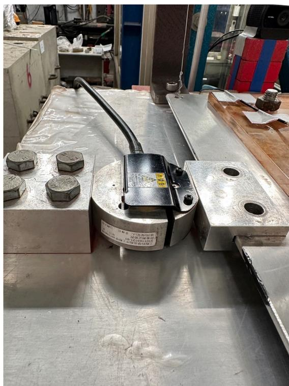
圖 3.9: 荷重元固接示意圖
