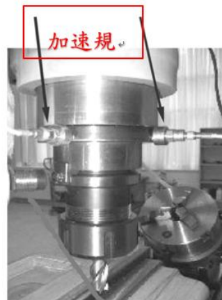
圖 2-2 加速規安裝在銑床主軸上[Ye007]
