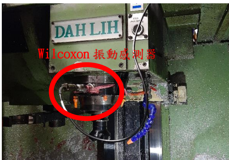
圖 3-4 Wilcoxon 振動感測器安裝於銑床主軸之照片
