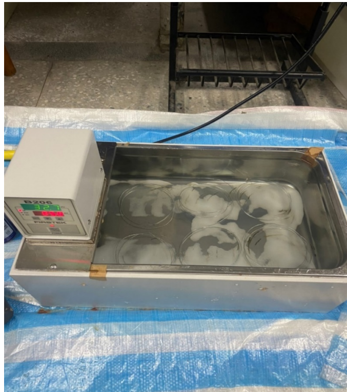
圖 3.11 腐蝕試驗設置
