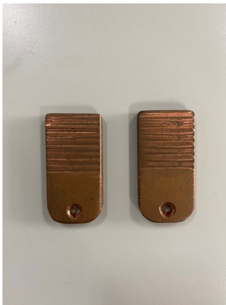
圖 3.15 拉伸機夾具夾持及固定試體之工件
