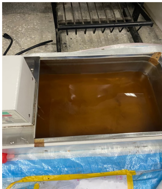
圖 3.12 七天腐蝕試驗結束後水槽內之鏽水
