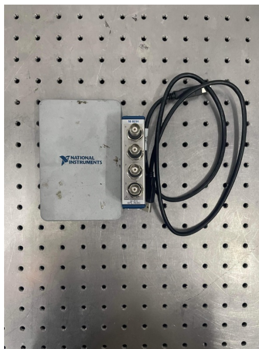
圖 3.6 加速規所使用之資料擷取器
