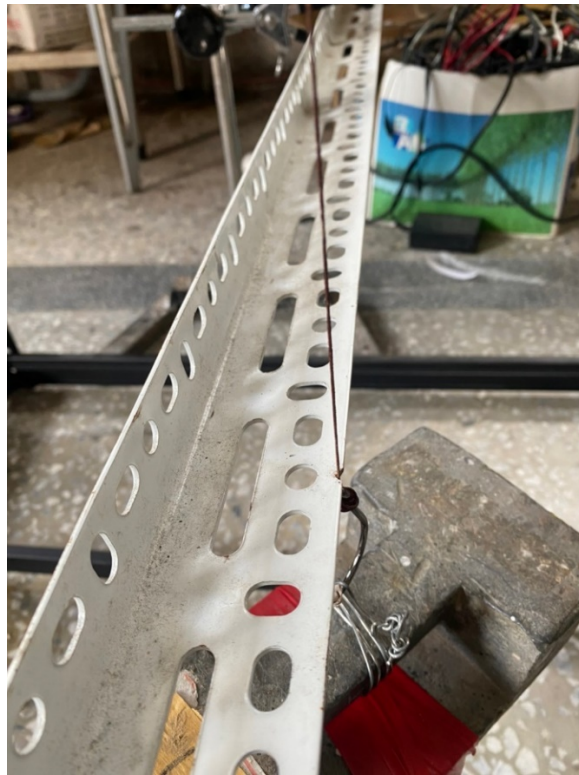
圖 4.3 以角鋼對鐵線下方端點進行簡單支撐示意圖
