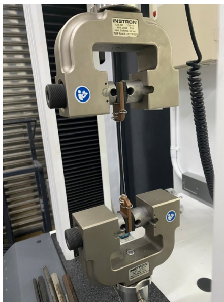
圖 3.13 抗拉試驗設置圖
