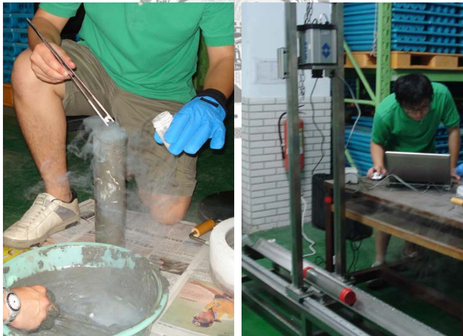
圖 5-2：以紅外線熱像儀對混入人工合成天然氣水合物之岩心管進行掃描攝影。
