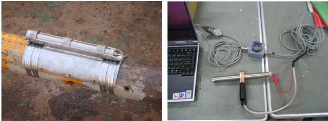
圖 2-3：附著式小型溫度探針。左圖為溫度探針繫掛於岩心管，右圖為溫度探針經由電腦下指令不需打開探針便可下載資料。
