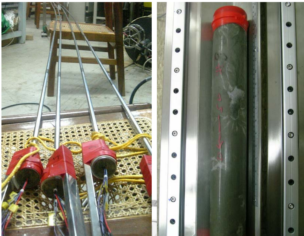
圖 3-4：紅外線熱像儀所施測的樣品。左圖為熱探針之針管，右圖為含有沉積物的岩心膠管。
