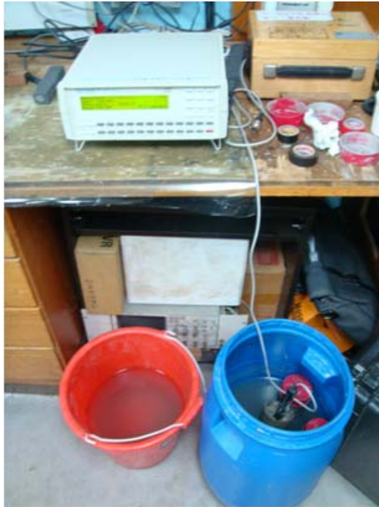
圖 2-5：將剛取得之岩心放置在冰水中量測熱導係數。
