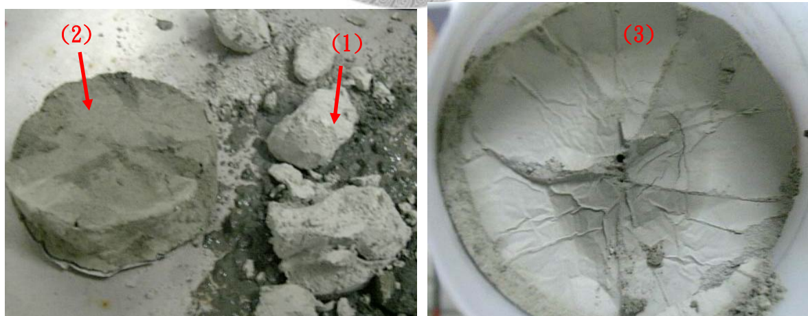
圖 5-8：將測試後的天然氣水合物取出觀察。左圖中第(2)層的沉積物較濕，是天然氣水合物解離產生水所造成；右圖為第(3)層的橫切面，在中間有較濕的沉積物，顯示出天然氣水合物確實在此解離。
