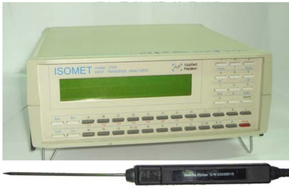
圖 2-4：熱傳導分析儀。下方為與主機連接之細熱導探針，將其插入岩心沉積物便可測量熱導係數。
