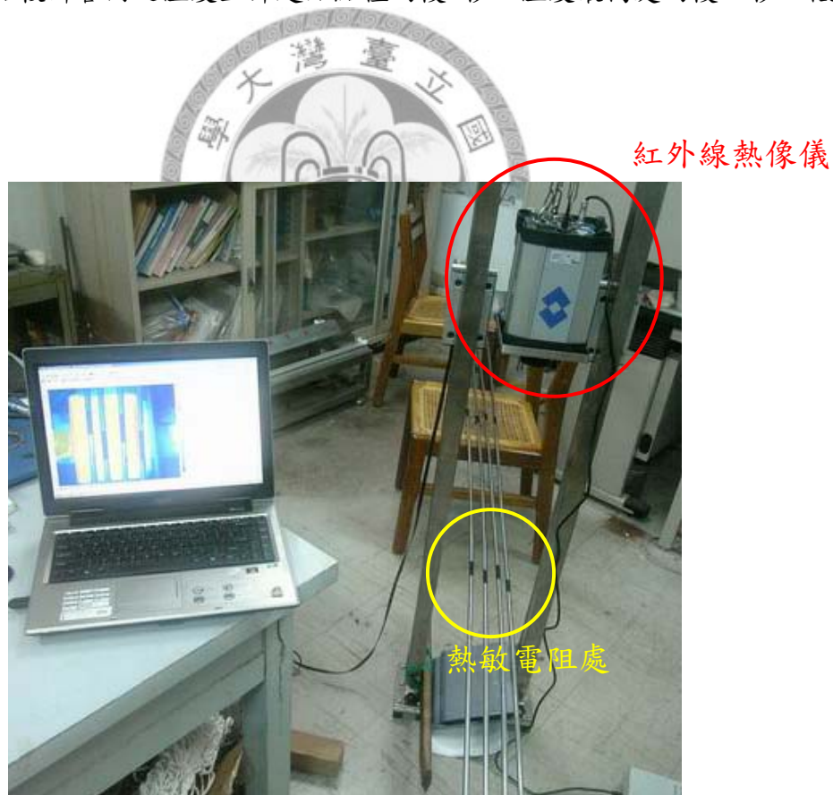
圖 4-6：紅外線熱像儀掃描熱流探針熱敏電阻處。紅圈處為紅外線熱像儀，黃圈內之黑色膠帶位置為探針管內有熱敏電阻之處。
