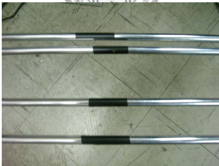
圖 3-5：在探針表面對應於針內之處熱敏電阻之處貼上一層薄薄的黑色膠帶以高放射率。
