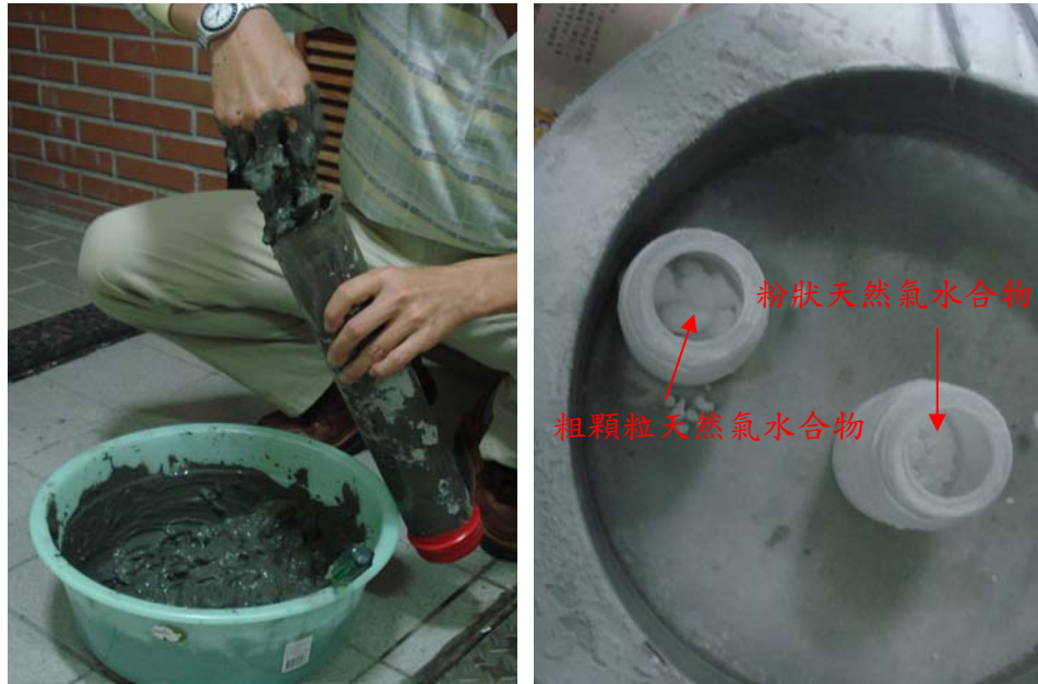
圖 5-1：在一約50公分長的岩心膠管中置入海床取得之沉積物及粗顆粒和細顆粒的人工合成之天然氣水合物。
