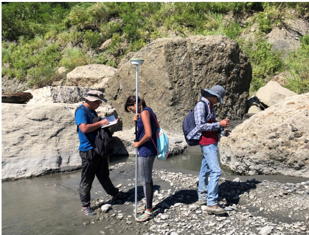
圖 3-5 RTK-GPS 移動站照片。野外測量時利用移動站天線接收來自衛星和基站的訊號進行即時解算，以此得到準確的坐標和高程。
