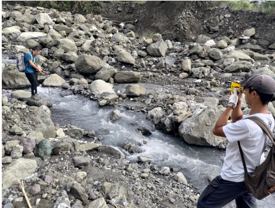
圖 3-6 雷射測距儀野外測量照片。雷射測距儀為右方人員手持黃色的儀器，利用鏡頭中的靶心瞄準稜鏡發射雷射，以此獲得兩點間的坐標與高程差。
