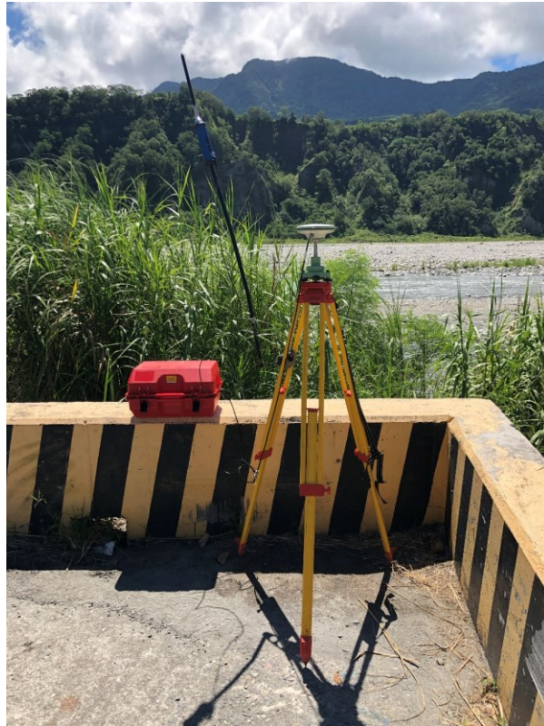
圖 3-4 RTK-GPS 基站照片。野外測量時基站天線正在接收來自衛星的訊號，且藉由左上方的無線電波發射器傳送給移動站進行即時解算。
