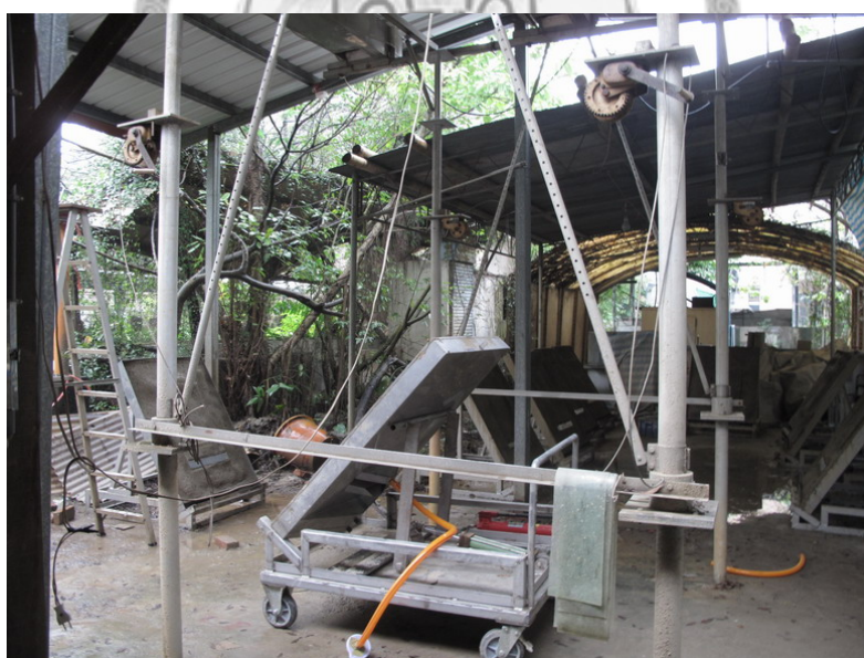
圖 3.13 試體裝設推車上移至雨場
