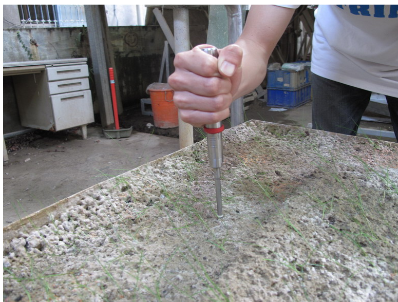
圖 3.12 量測試體表面強度
