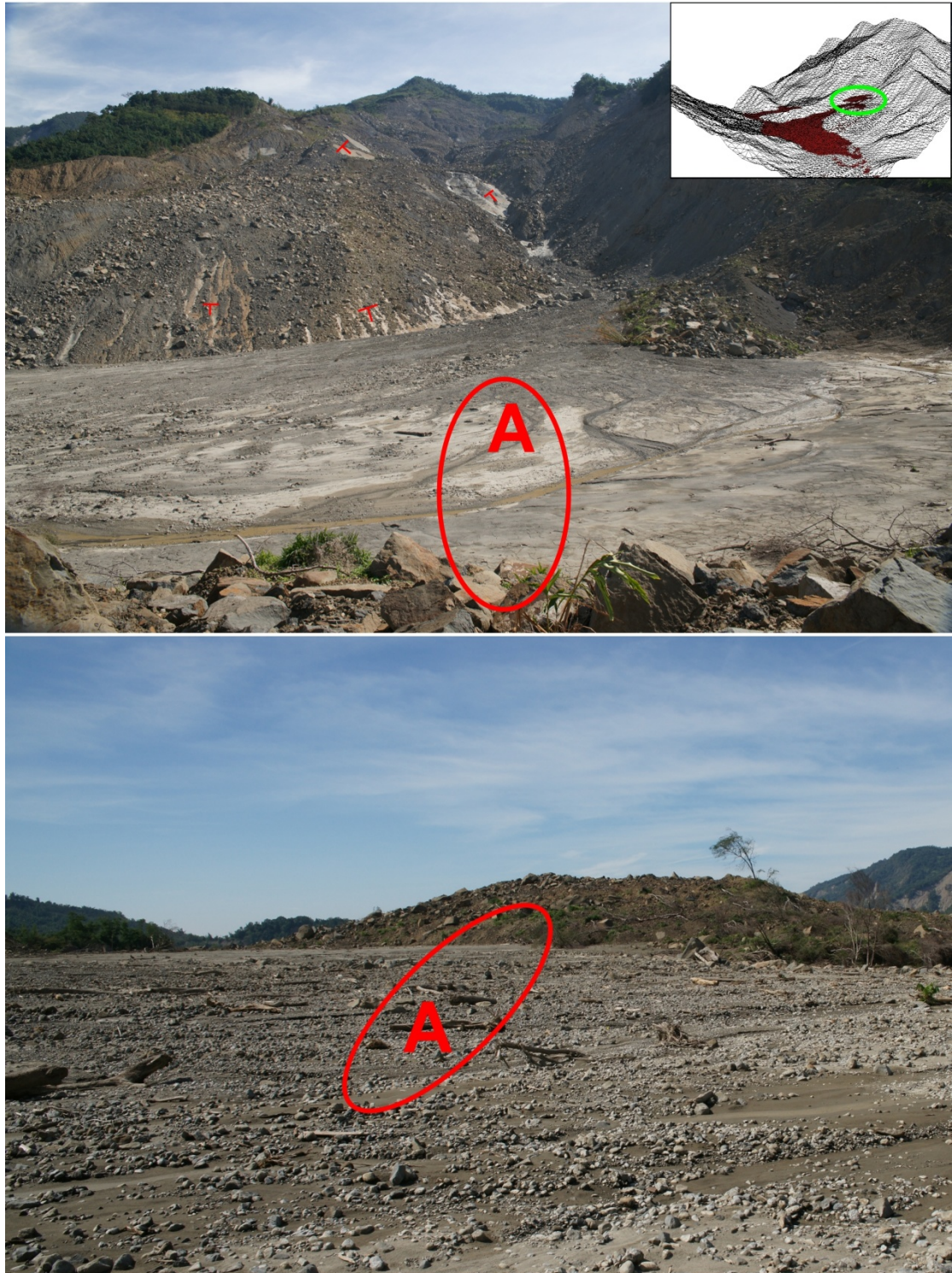
圖 5- 21：A 點為一凸起小高地位置，經野外實地調查與地形比對發現幾乎已呈現平坦地形。圖 9 的 A 點位置 (590 高地) 已被強大的岩屑流削去大半，並轉為平坦如沖積扇之堆積地形。
