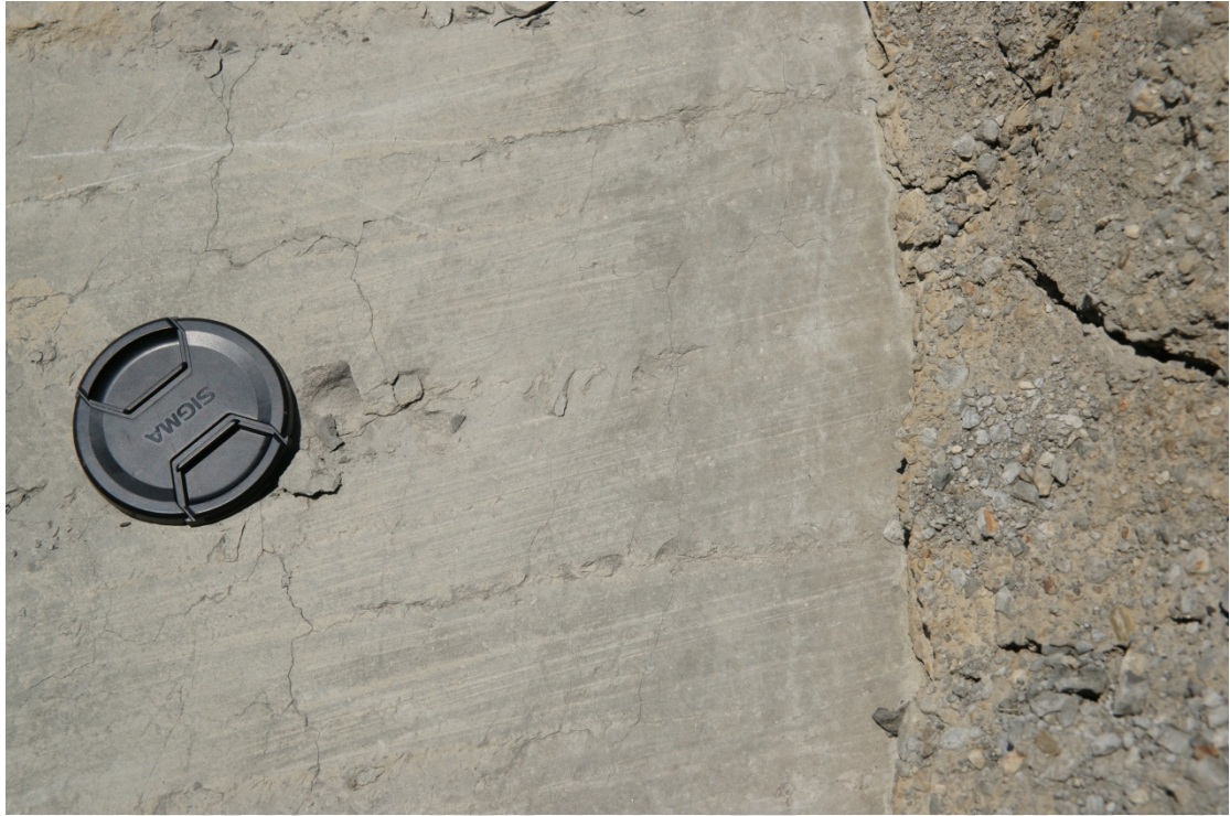
圖 5-7：在崩塌區河谷的邊緣可見岩石摩擦的痕跡，其方向和土石流動的方向相同。
